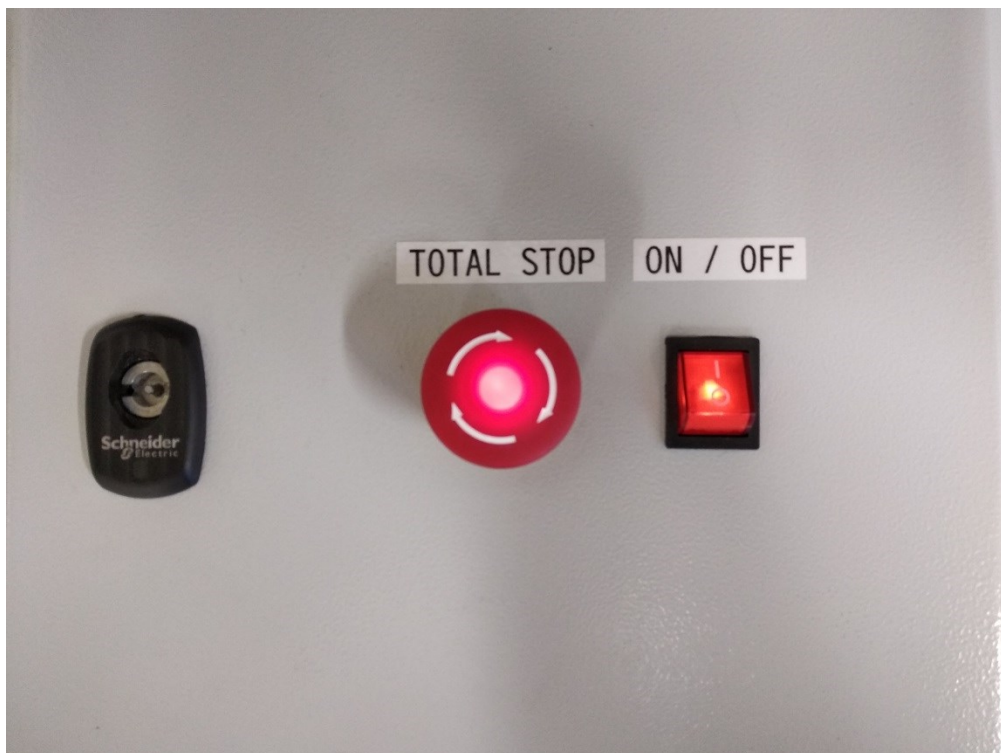
Obrázek 36 – Umístění tlačítka nouzového zastavení
