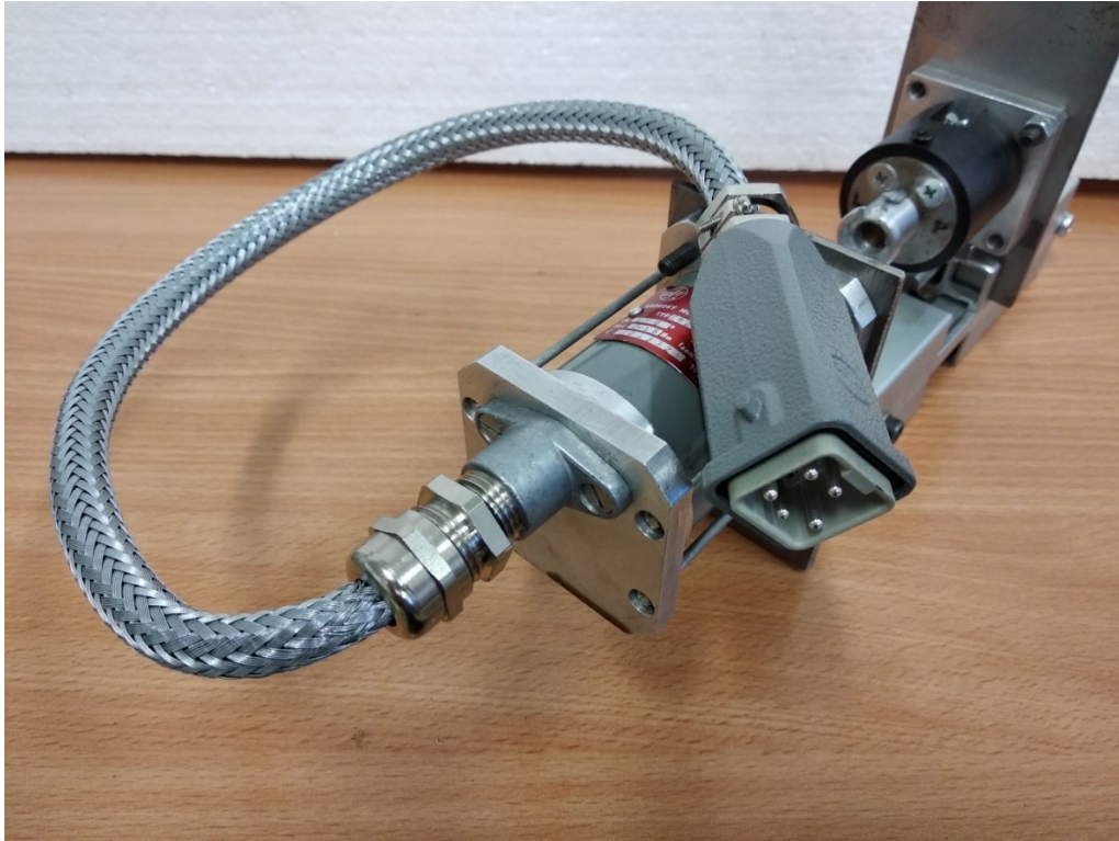
Obrázek 39 – Úprava přívodního kabelu krokového motoru
