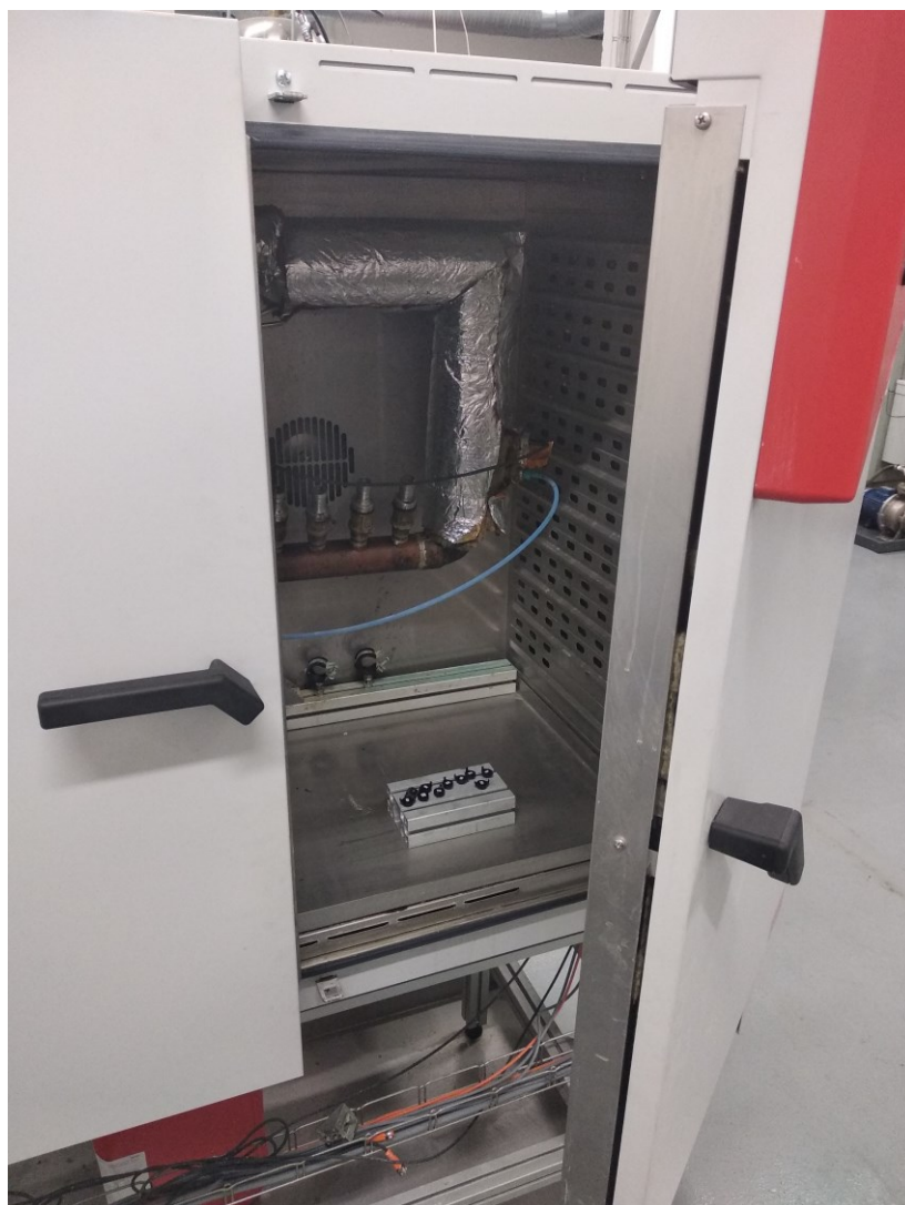
Obrázek 49 – Temperování vzorků v klima komoře
