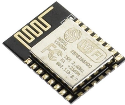
Obrázek 36: WiFi modul ESP8266. [36]
