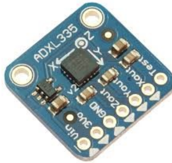
Obrázek 31: 3osý akcelerometr ADXL335. [34]
