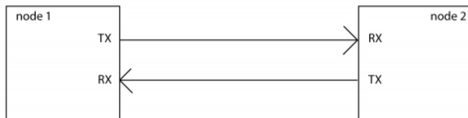
Obrázek 16: Obousměrná komunikace – schéma propojení pinů. [30]
