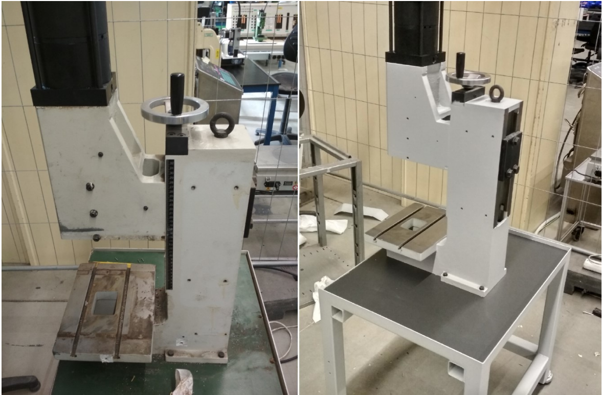
Obrázek 52 Rozdíl mezi původním a renovovaným lisem
