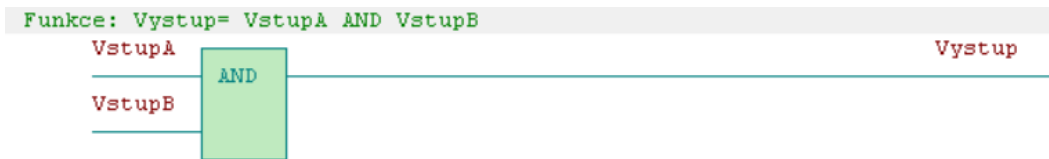
Obrázek 1.8 Příklad programového kódu v grafickém jazyku FBD
