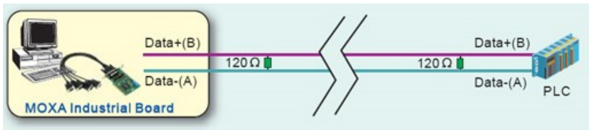
Obrázek 1.12 Propojení dvou zařízení na sběrnici RS-485[8].
