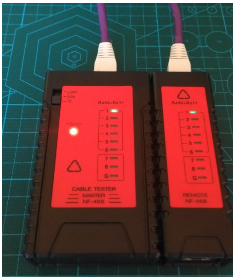
Obrázek 23 – UTP – kontrola krimpování
