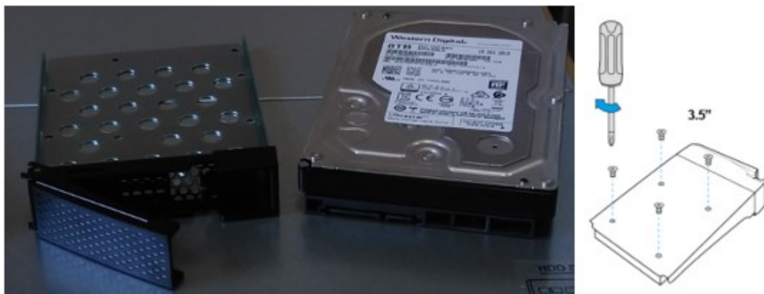
Obrázek 17 - NAS – Montáž pevných disků do kazet
