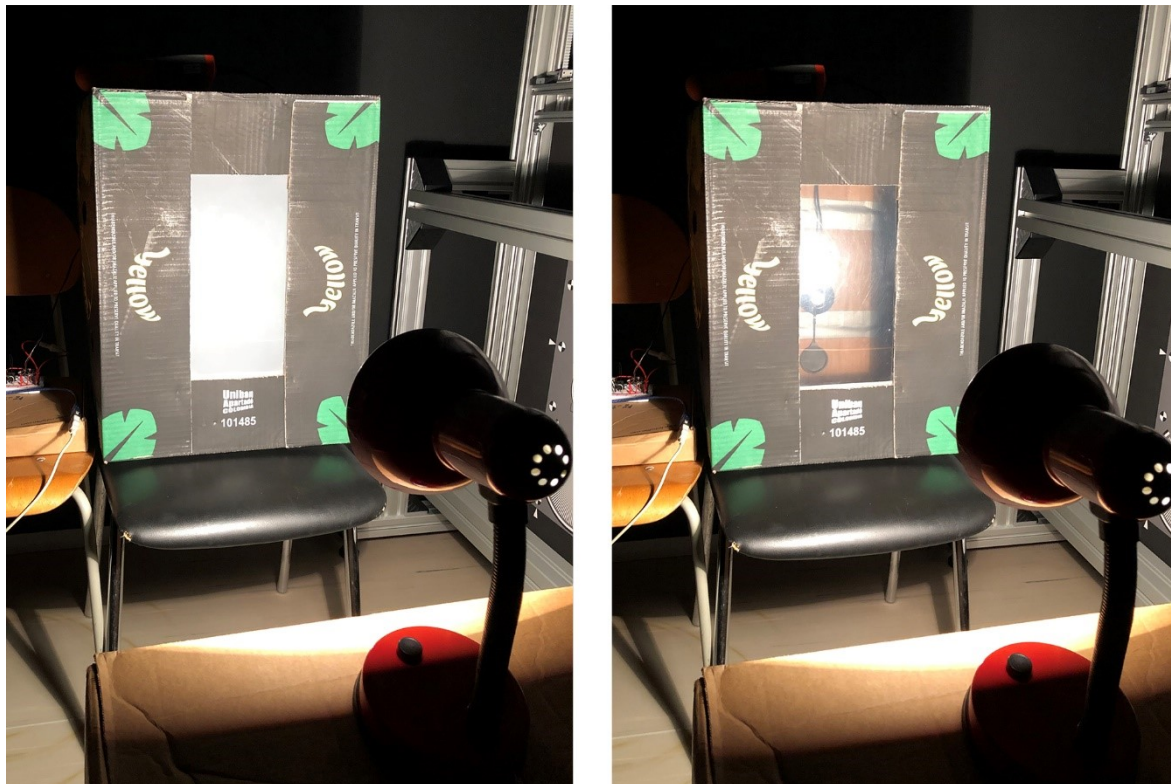
Obr. 31 – Měření propustnosti světla PDLC fólií při různé úrovni transparentnosti; vlevo 0 %; vpravo 100 % [vlastní]
