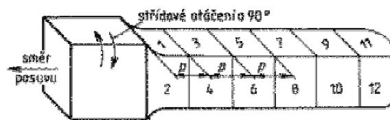
Obr. 28 Postup úderů při prodlužování čtyřhranu – „kování na sebe“
