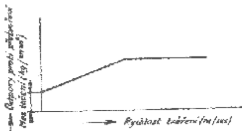
Obr. 1 Závislost přetvárných odporů na rychlosti tváření
