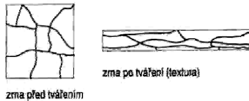
Obr. 3 Změna zrn tvářením
