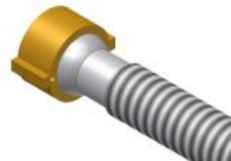
Obr. 71 Schéma kulového čepu a vložky
