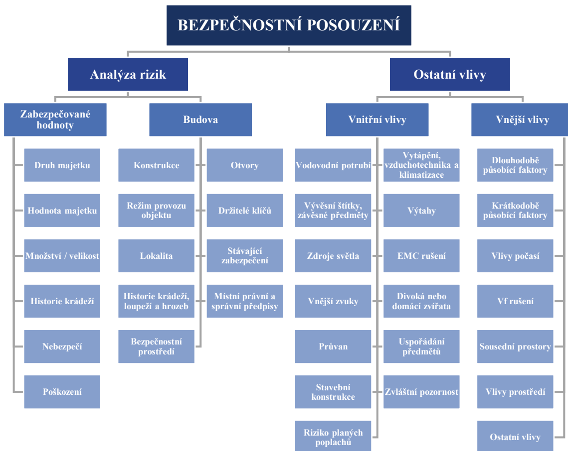
Obr. 11. Přehled bezpečnostního posouzení objektu [6]
