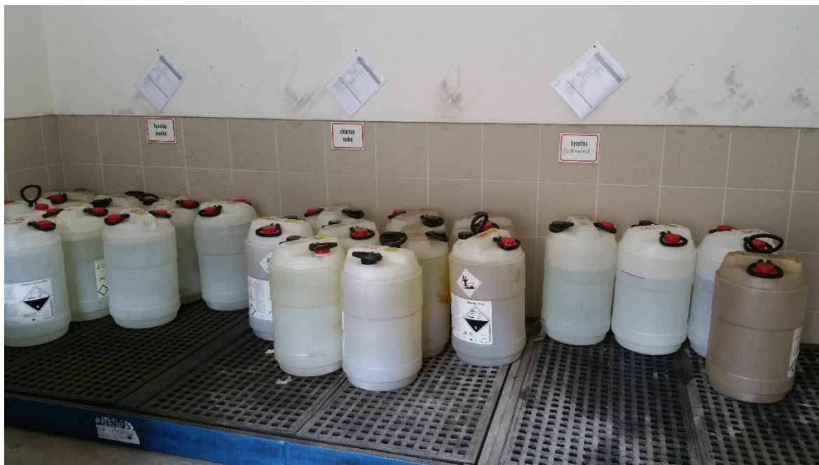
Obrázek 3 – Uložení nebezpečných chemických látek a směsí, zdroj: [vlastní]
