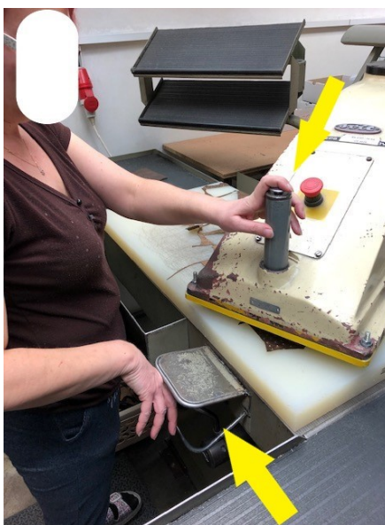
Obrázek 10 Dvoutlačítkový bezpečnostní systém [18]
