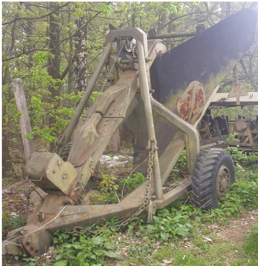
Obrázek 3 - zákopový pluh ZP 60/90
