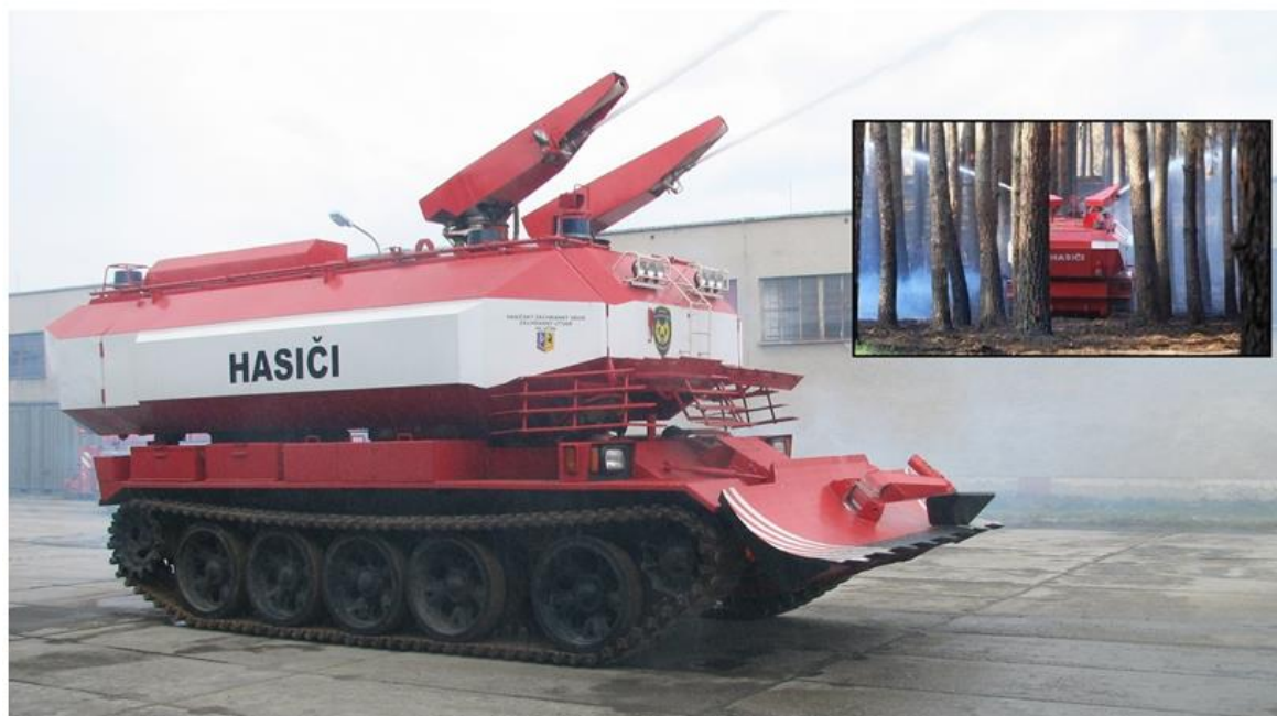
Obrázek 12 – Speciální požární pásové vozidlo SPOT-55 [12]
