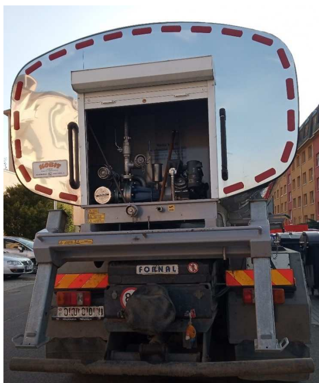
Obrázek 12 - Tatra 815 kontejner pro přepravu pitné vody (zadní pohled) [vlastní]
