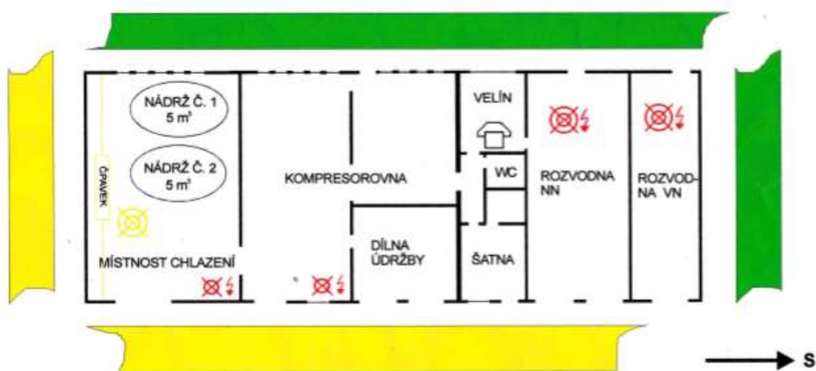
Obrázek 12 Výkresová dokumentace objektu strojovny a trafostanice
