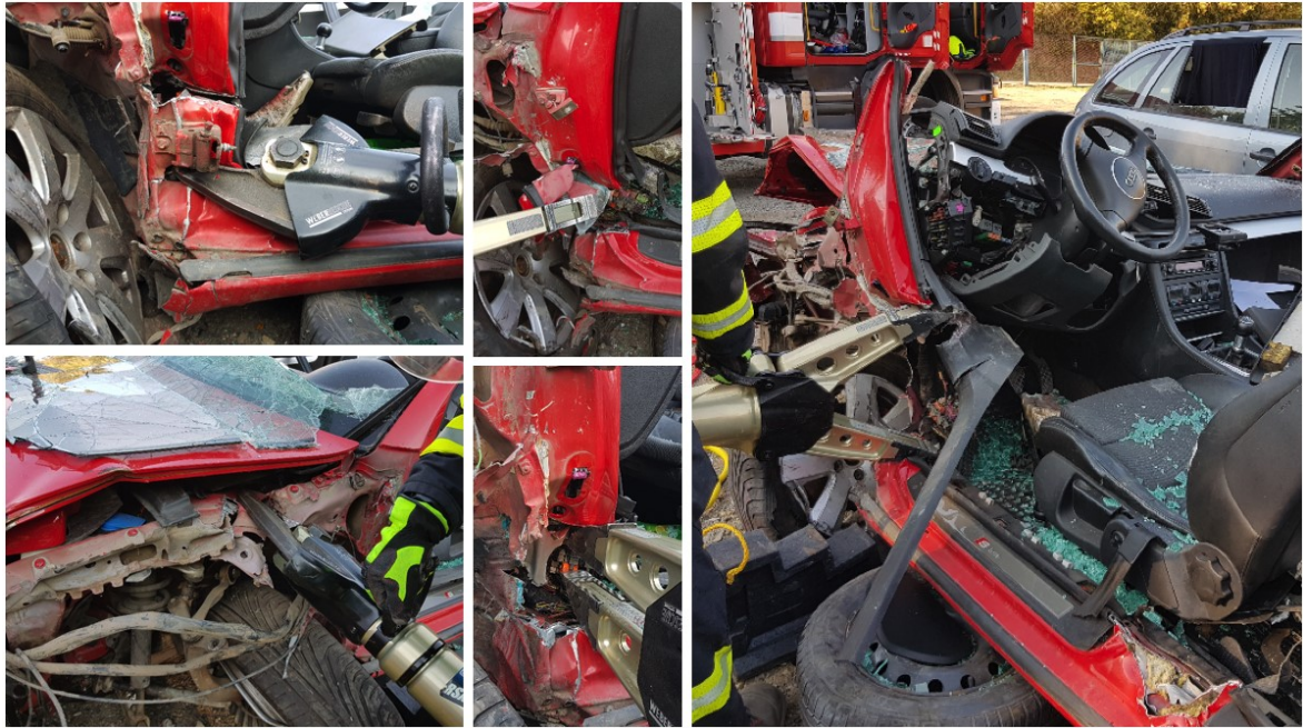
Obrázek 10 Odtažení palubní desky hydraulickým rozpínákem [vlastní], [HZS Jmk]
