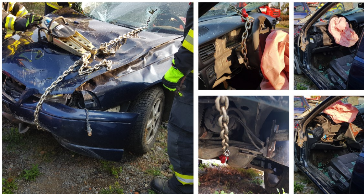
Obrázek 9 Odtahování volantové tyče [vlastní], [HZS Jmk]
