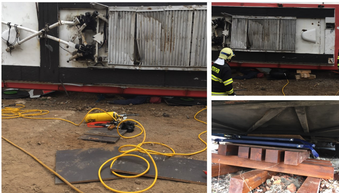
Obrázek 14 Vyproštění osoby pomocí zvedacích vaků [vlastní], [HZS Jmk]
