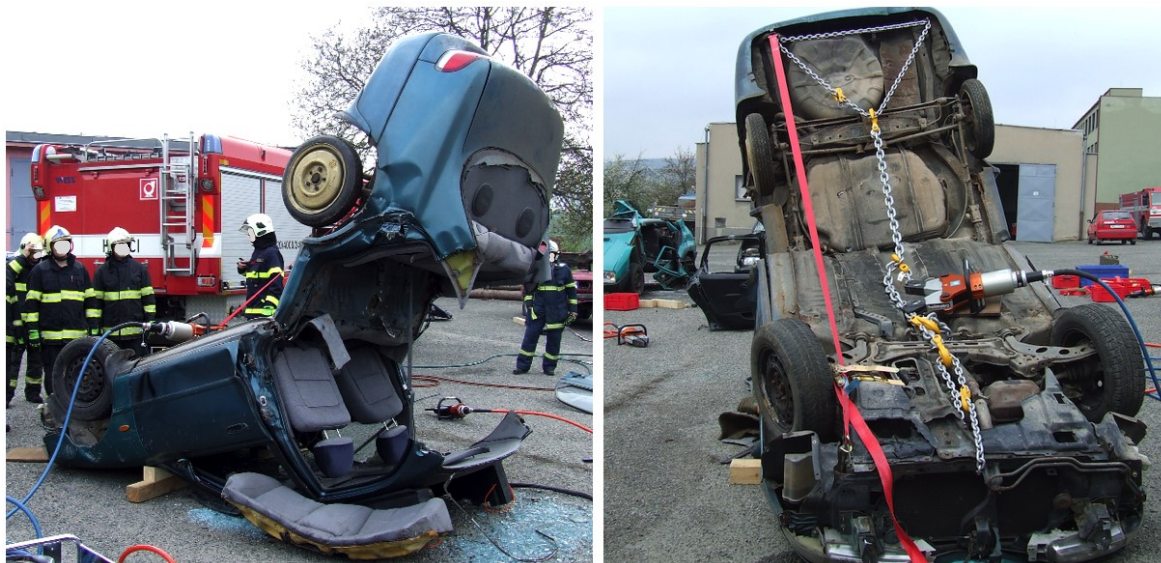
Obrázek 8 Odklon zadní části vozu [vlastní], [HZS Jmk]
