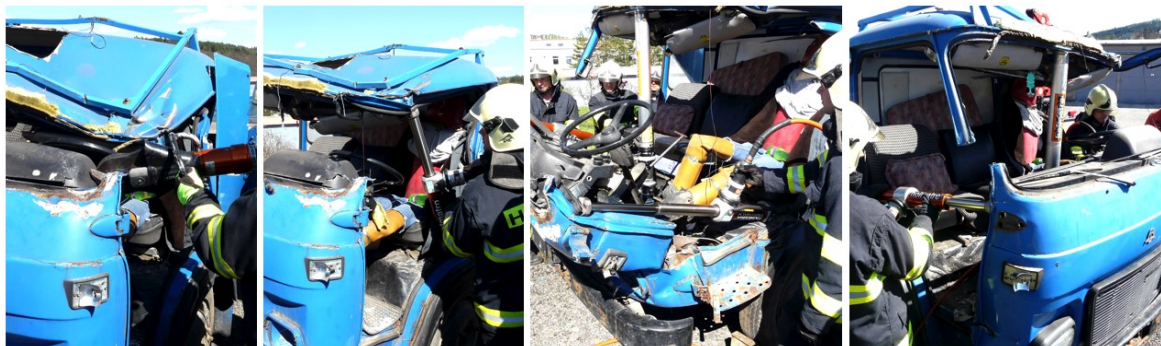
Obrázek 12 Odtažení palubní desky nákladního automobilu [vlastní], [HZS Jmk]
