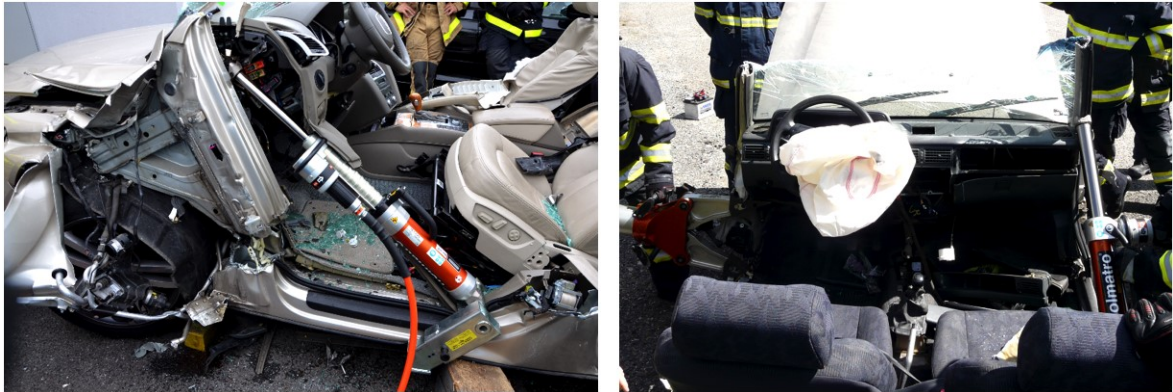
Obrázek 11 Odtažení palubní desky rozpěrným válcem [vlastní], [HZS Jmk]
