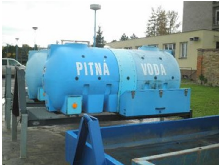
Obrázek 12 - Kontejnerová cisterna [Zdroj: VaK Kroměříž a.s.]
