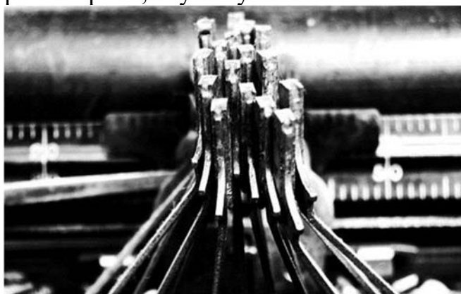
Ilustrace 10 Zaseknutá kladívka psacího stroje
