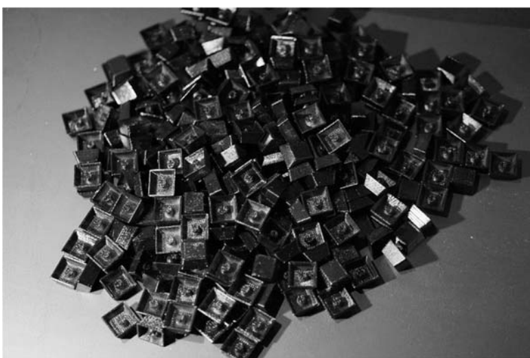
Ilustrace 76 3D tištěné klávesy před povrchovou úpravou
