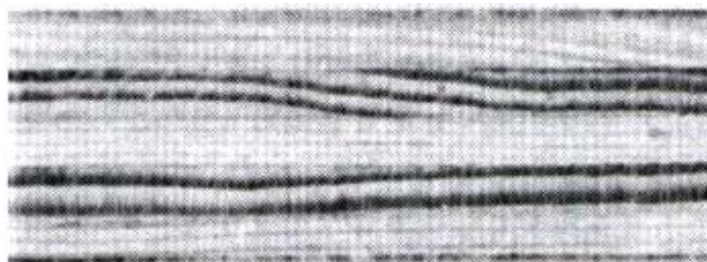
Obr.6.1: Jeden z nejznámějších laminárních kompozitů – dřevěná překližka
