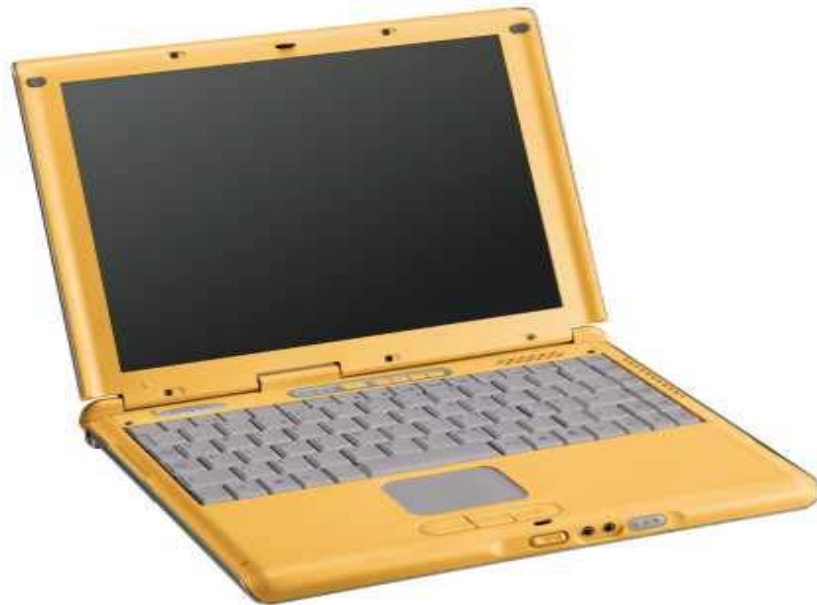
Obr.4.16: Odolné víko notebooku firmy Asus z magneziové slitiny
