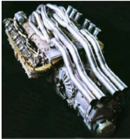
Obr.4.31: Použití žárovevné niklové slitiny pro extrémně namáhané spalovací motory
