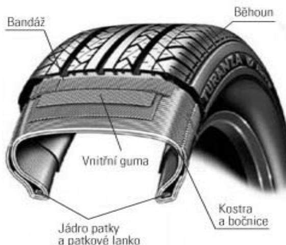
Obr.5.37: Základní struktura pneumatiky
