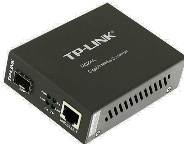
Obrázek 28: Konvertor Optika/Ethernet Tp-link MC220L [30].
