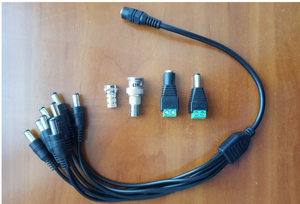
Obrázek 76: Konektory kamerových rozvodů včetně rozvaděče CCTV adaptéru.
