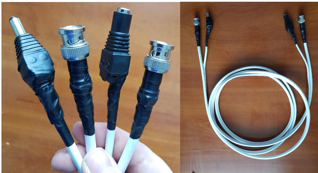
Obrázek 78: Osazování konektorů BNC/DC dokončení.
