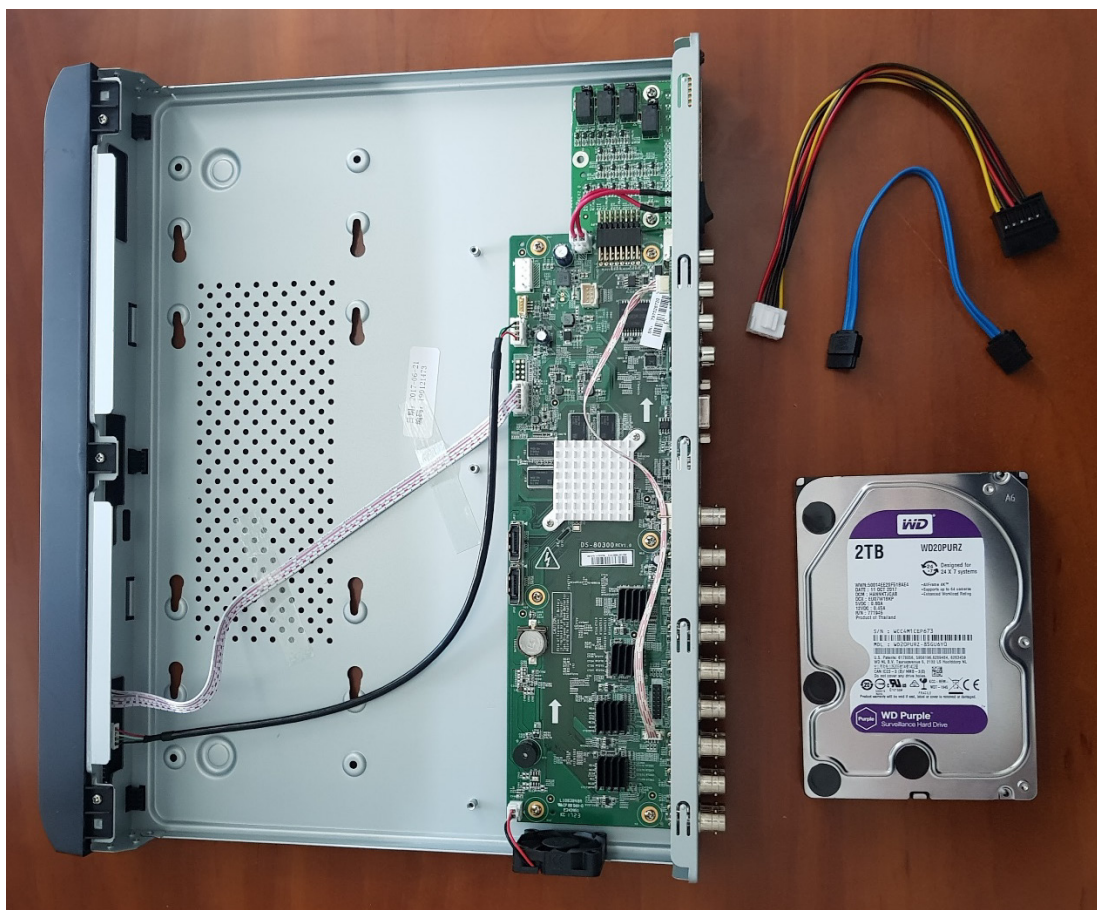
Obrázek 83: Příprava instalace HDD do DVR rekordéru.
