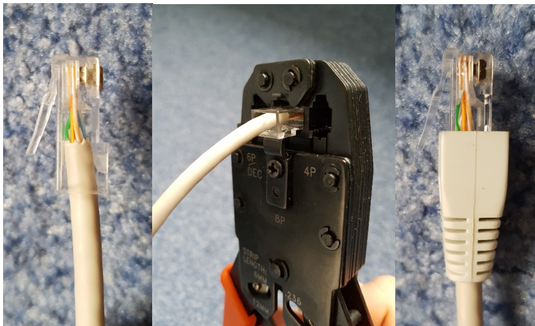
Obrázek 60: Osazení konektoru RJ45 (část 2)
