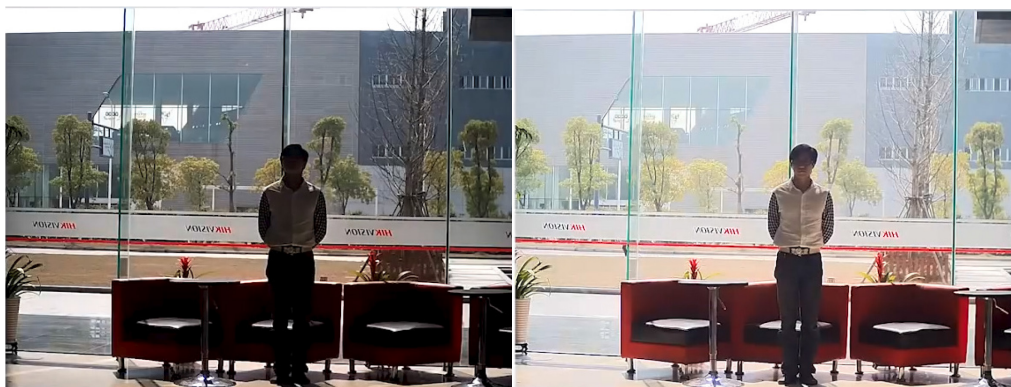
Obrázek 16: WDR (Wide Dynamic Range) OFF/ON [25].
