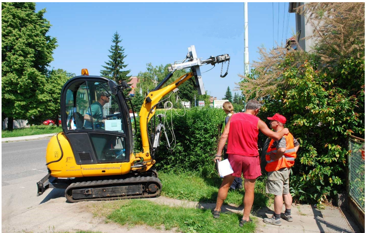
Obrázek 24: Provádění zkoušek pevnosti a stability stožárů VO
