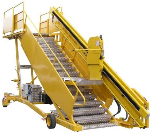
Obr. 7. Letištní schodišťová plošina Ikaros[16]
