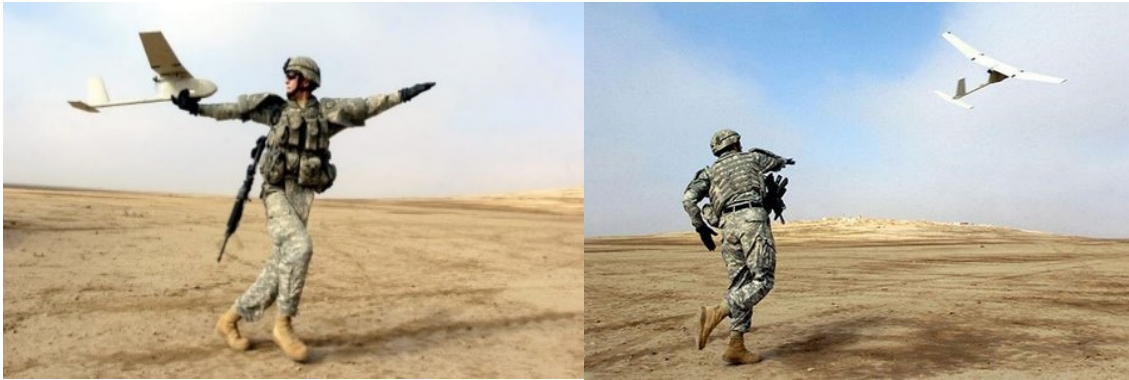
Obrázek 2: Startování RQ -11 Ravenů z rukou (Zdroj: www.google.cz )
