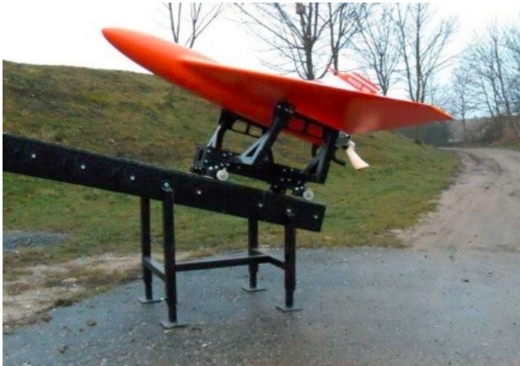
Obrázek 3: Startování HAES 400 Aerial Target z rampy (zdroj: www.google.cz )
