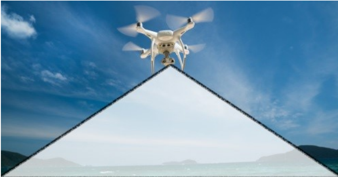
Obrázek 18: Rozsah výhledu bezpilotního leteckého prostředku- bílý kužel zohledňuje míru sledování objektu, kameru nelze natáčet, natáčí se sama v rámci letu (Zdroj: obázek upravený Bc. Marcelou Janůvovou ze zdroje https://echo24.cz/a/pe7CW/australie-testuje-bezpilotni-letoun-proti-zralokum )
