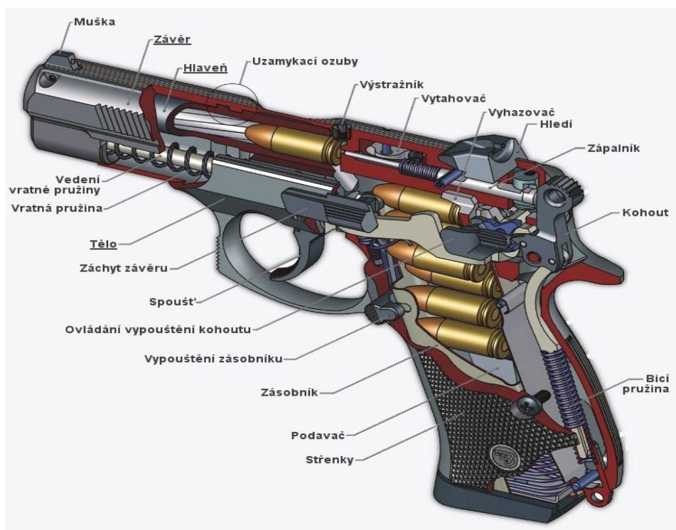
Obr. 3. Hlavní části a ovládací prvky pistole [5]
