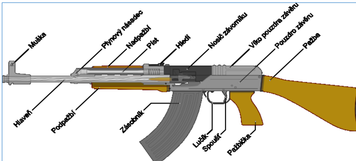
Obr. 5. Hlavní části a ovládací prvky samonabíjecí pušky [5]
