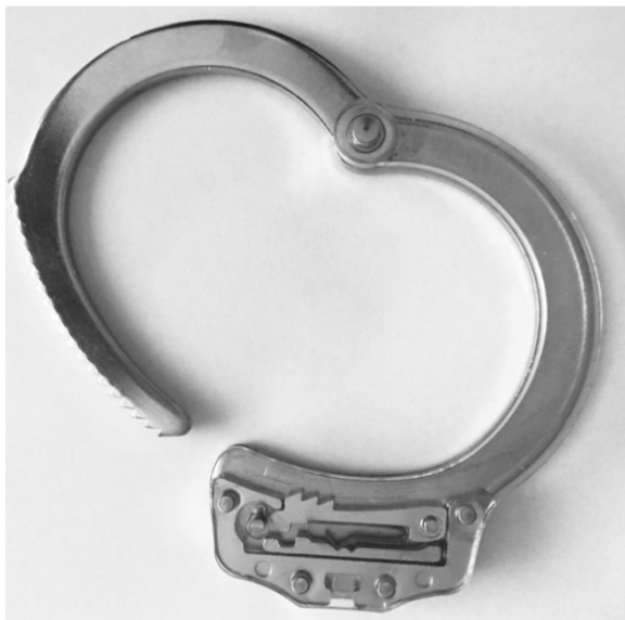
Obr. 36. Kovové putá s viditeľným zámkovým systémom [vlastný zdroj]
