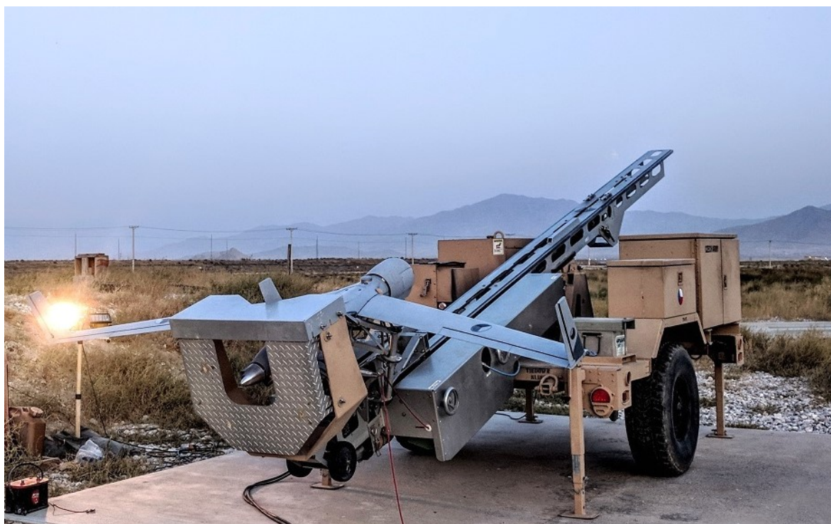
Obr. 11. Start Scan Eagle pomocí katapultu [33]
