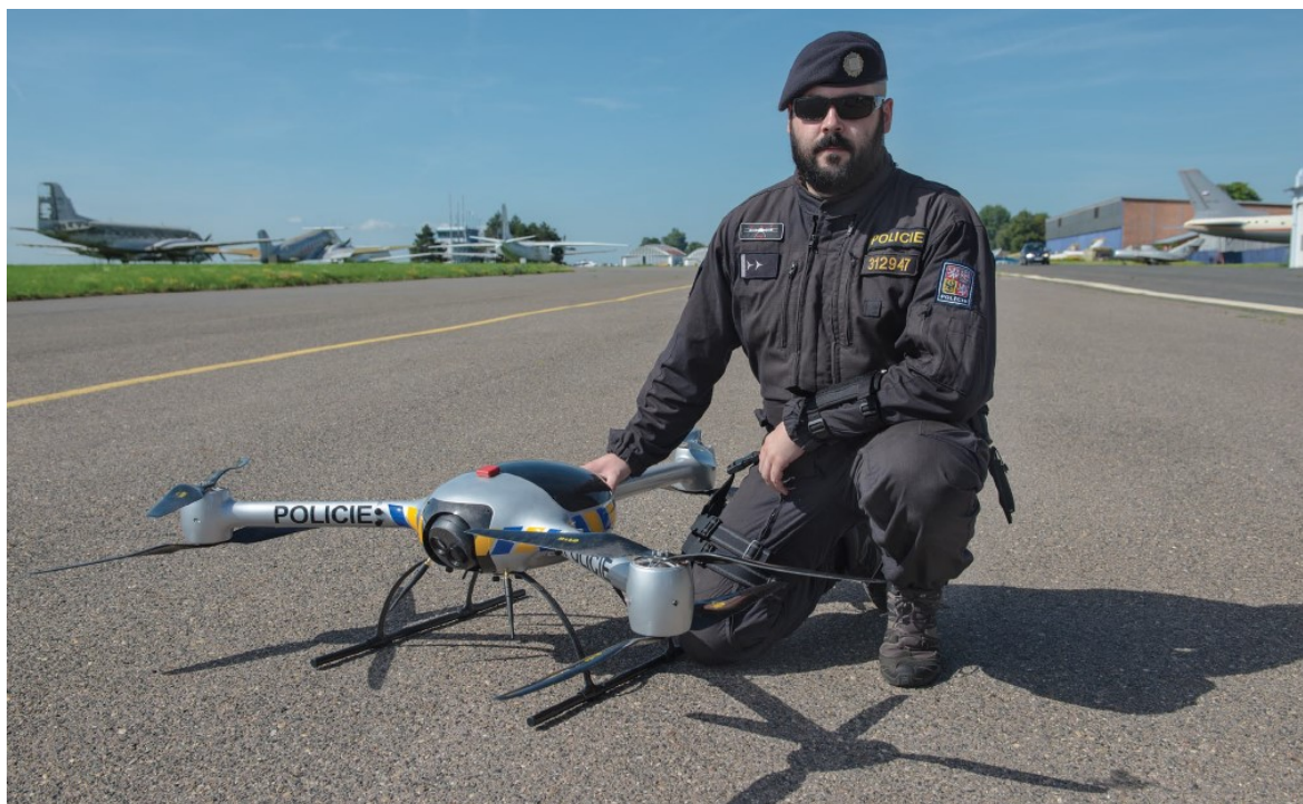
Obr. 22. UAS PČR BRUS je vybaven šesti tichými rotory a kamerovým systémem s nočním viděním a termovizí [44]
