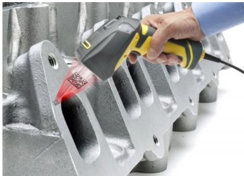
Obr. 6 Verifikátor při kontrole označení bloku motorů [9]
