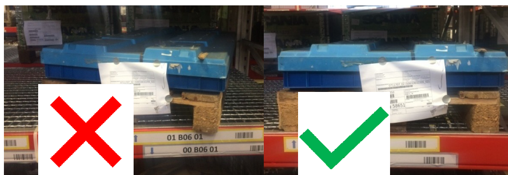
Obr. 42 – Ukázka špatného a správného zaskladnění (vlastní zpracování)
