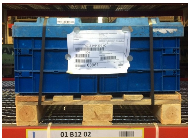
Obr. 41 – Správně zaskladněná bedna (vlastní zpracování)
