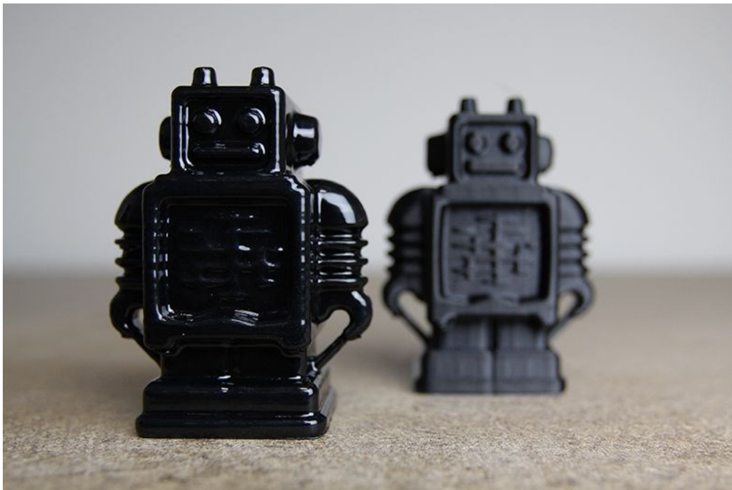
Obr. 17. Leptaný model (vlevo), neupravený model (vpravo) [18]
