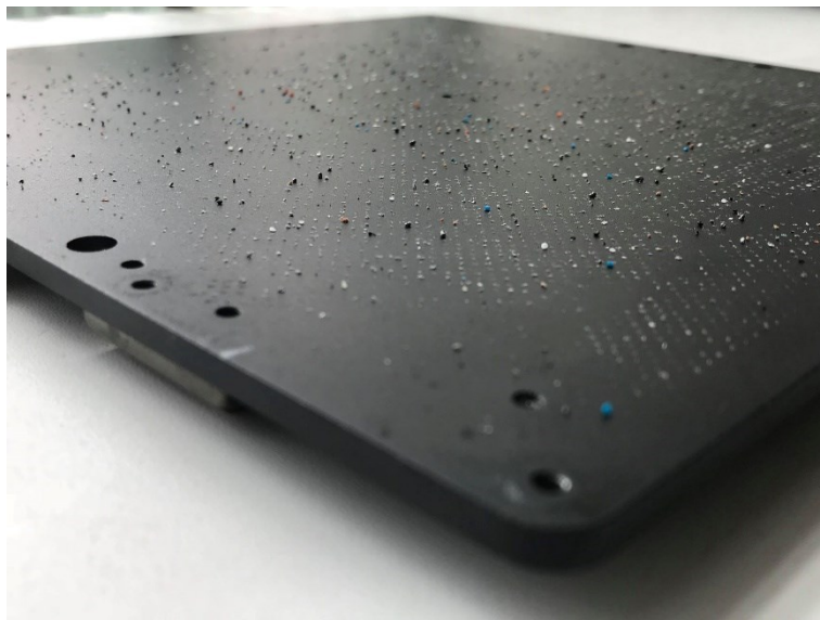
Obr. 52. Znečištění tiskové desky
