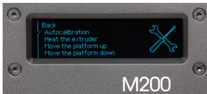
Obr. 27. Autokalibrace 3D tiskárny Zortrax M200
