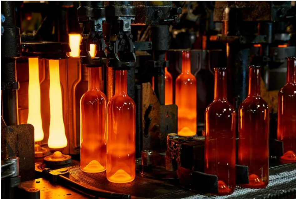
Obr.6. vínne fľaše vychádzajúce z konečnej formy, za nimi sa pripravuje ďalšie množstvo materiálu do formy
