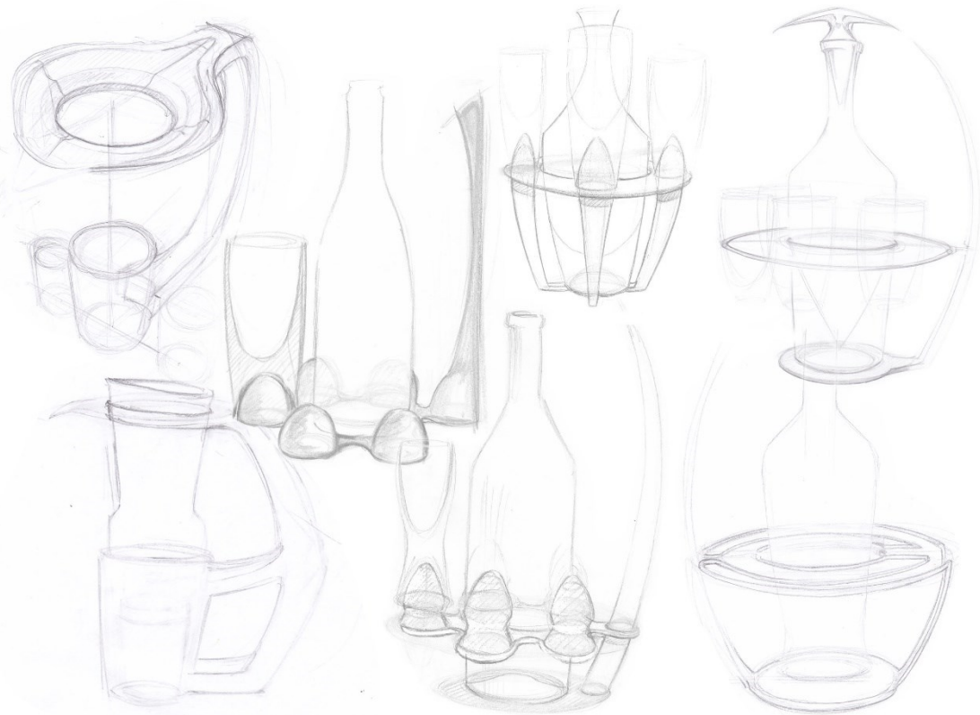
Obr. 25. Postupný vývoj designu od plných materiálov po myšlienku ohýbaného drôtu
