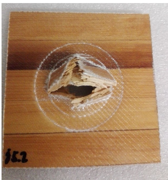
Obr. 99. Porucha referenčního vzorku j
