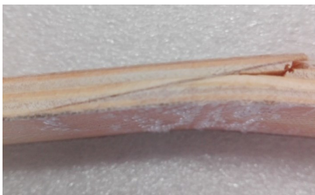
Obr. 92. Porušení v rovině spoje (vzorek b2)
