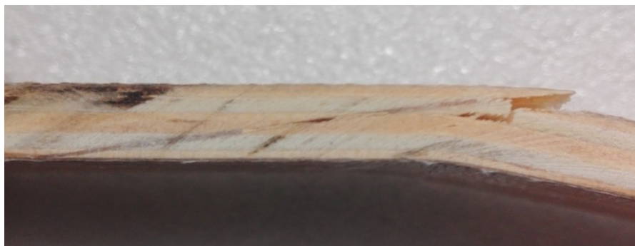
Obr. 90. Jediné porušení v rovině spoje u vzorku d1
