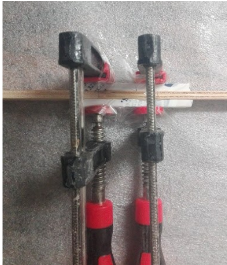
Obr. 61. Utažení překližkového spoje
