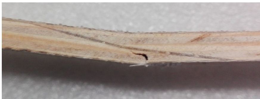
Obr. 89. Šíření trhliny mimo rovinu spoje (vzorek b1)
