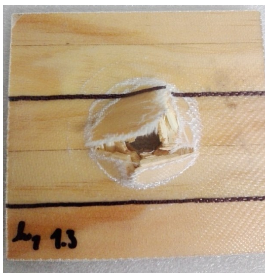
Obr. 100. Porucha vzorku h1
