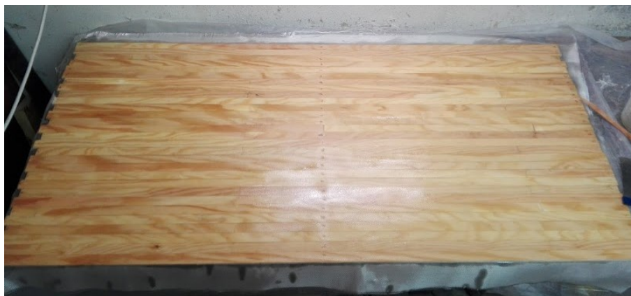
Obr. 77. Hotová překližková deska z celkovými dvěma vrstvami výztuže
