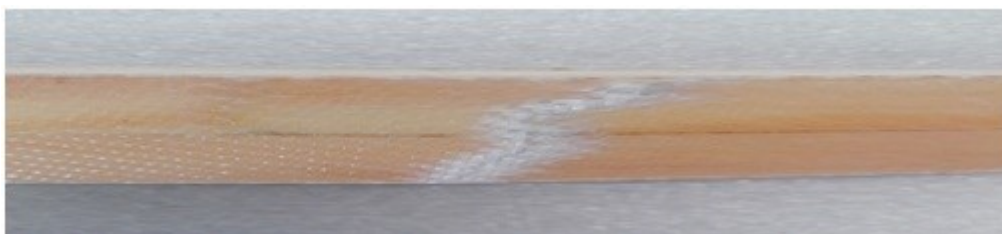
Obr. 91. Nejčastěji vyskytující se porucha (lokální poškození bez poruchy spoje)
