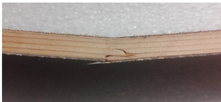
Obr. 85. Mírné smykové poškození vzorku f
