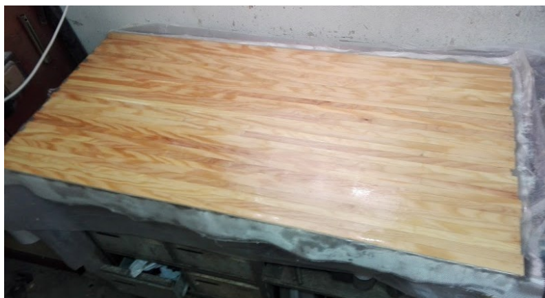
Obr. 79. Hotová překližková deska s celkovými čtyřmi vrstvy výztuže
