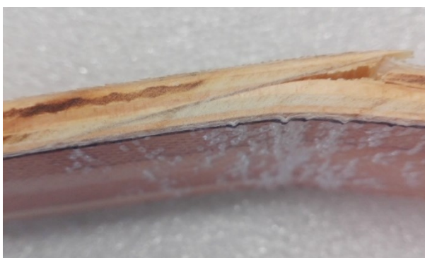
Obr. 93. Porušení v rovině spoje (vzorek d2)
