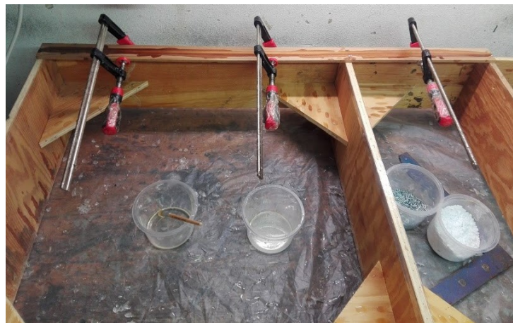
Obr. 66. Stažení cedrových latí svěrkami
