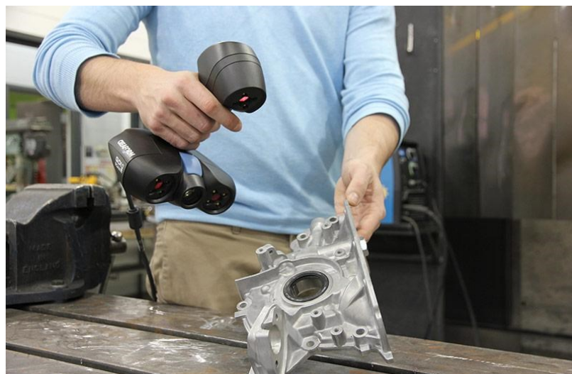
Obr. 6 Ukázka bezdotykového skenování [16]
