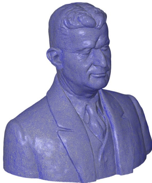
Obr. 30 Znárodnění síť vytvořené z 150 000 bodů
