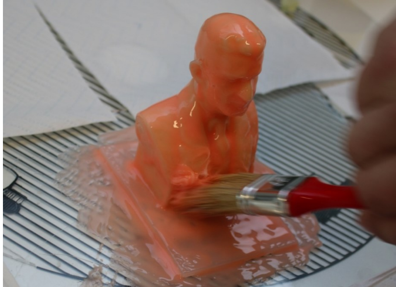
Obr. 46 Nanášení 1. vrstvy Rebound 25
