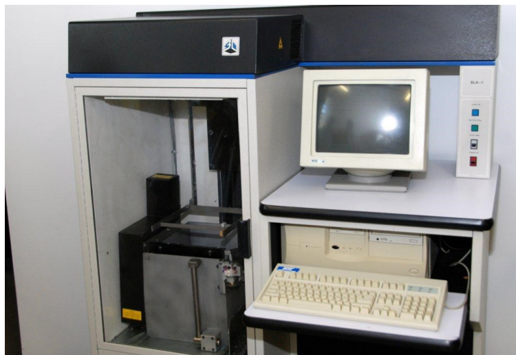
Obr. 14 3D tiskárna SLA-1, vytvořená Charlesem Hullem [26]
