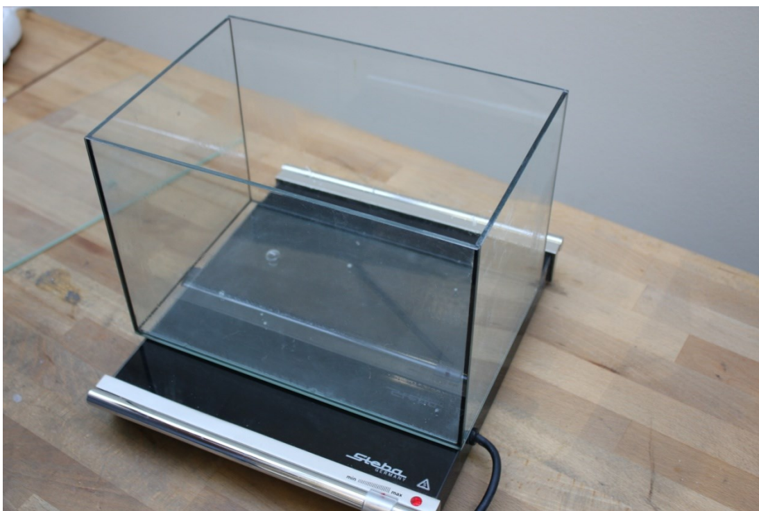
Obr. 38 Aparatura pro vytvoření acetonových výparů
