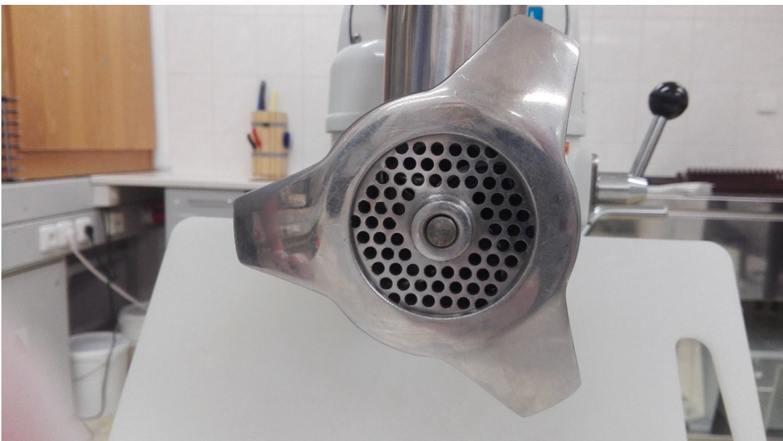
Obr. 8. Detail řezné desky s kruhovými otvory 5 mm
