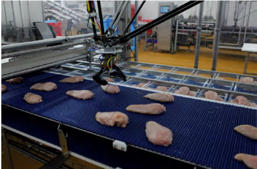
Obr. 1. Robotický systém schopný třídit a balit 300 filetů z kuřecích prsou za minutu
