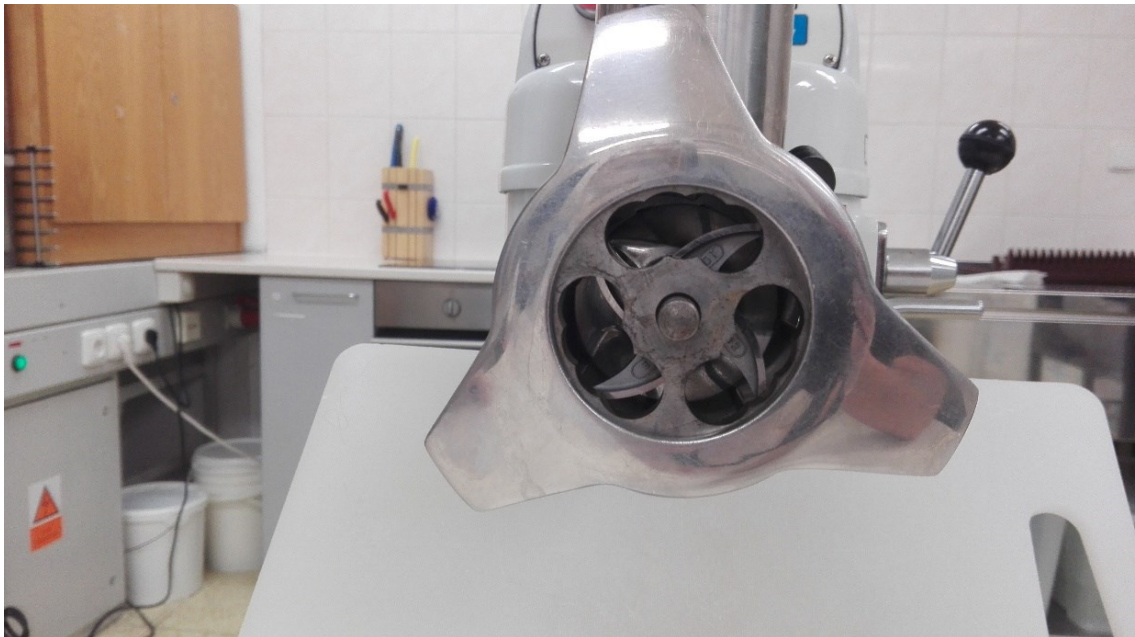
Obr. 7. Detail řezné desky tvaru ledviny
