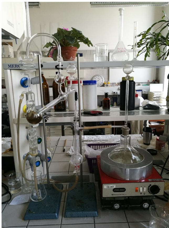
Obrázek 17 – Aparatura Parnas-Wagnerovy destilace
