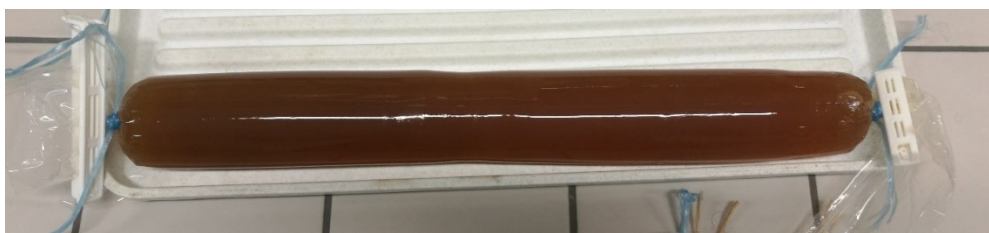
Obrázek 14 – Celulózová membrána naplněná kapalným keratinovým hydrolyzátem
