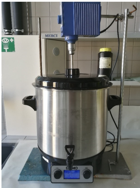
Obrázek 11 – Zařízení pro přípravu keratinového hydrolyzátu
