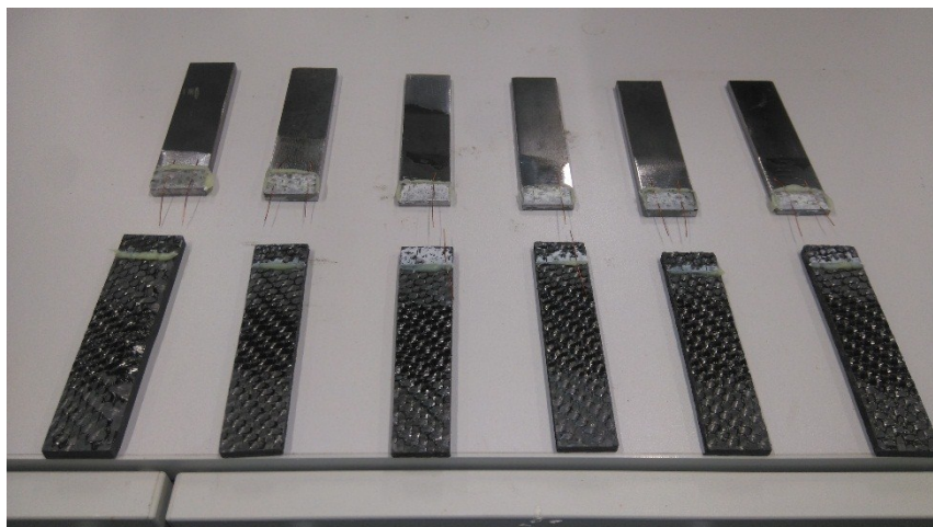
Obr. 71 Vzorky skupiny BK-Z po provedení smykové zkoušky
