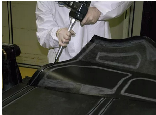
Obr. 17 Nanášení polyuretanového lepidla [21]
