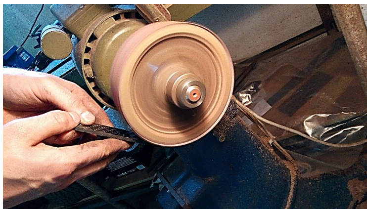
Obr. 58 Zdrsnění vzorků na brusném kotouči
