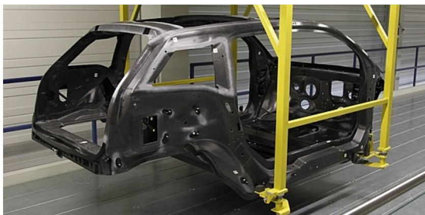
Obr. 10 Použití uhlíkových vláken u pevné karoserie automobilů [14]
