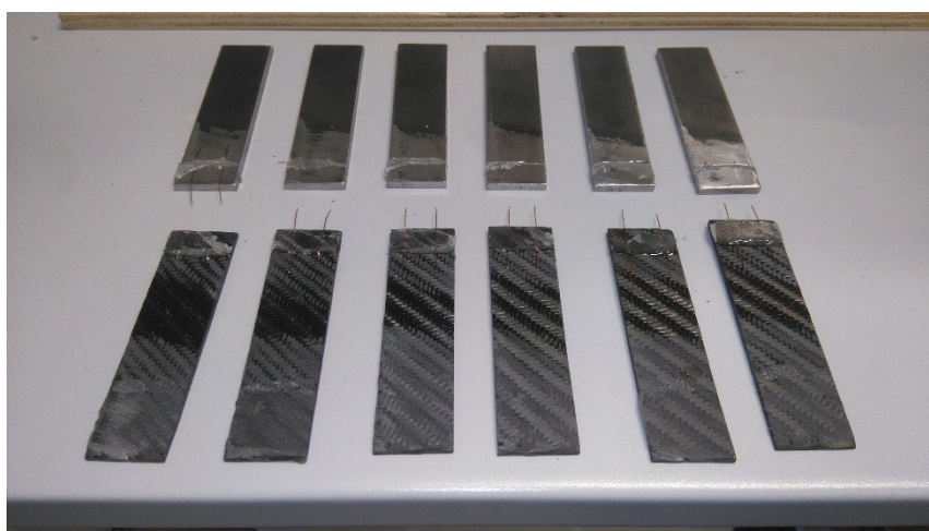
Obr. 69 Vzorky skupiny BK-X po provedení smykové zkoušky
