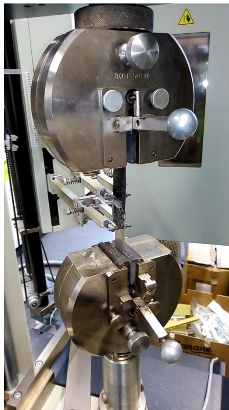
Obr. 65 Detail upnutého zkušebního adherendu v čelistech přístroje
