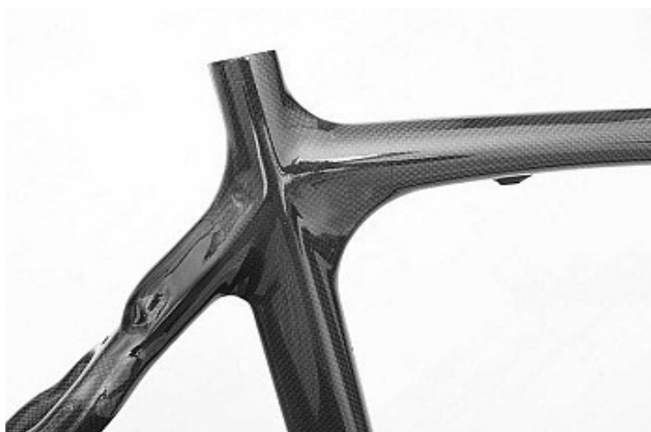
Obr. 12 Karbonový rám jízdního kola [15]
