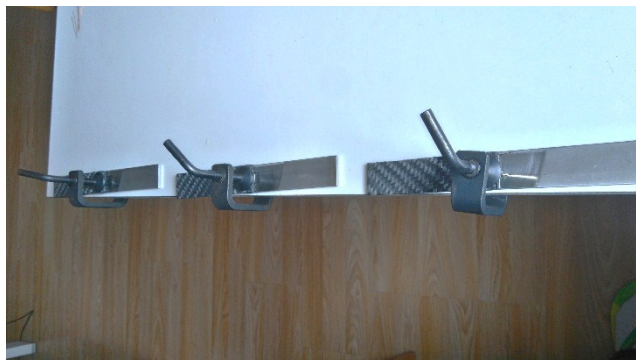
Obr. 59 Zatížené vzorky po lepení
