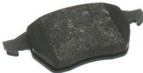
Obr. 50 Destička s třecím materiálem typu “NAO” [45]
