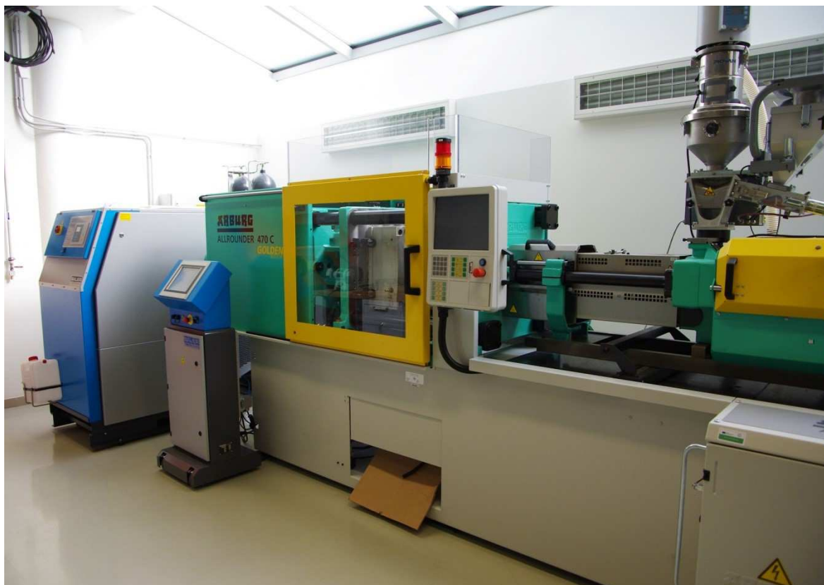
Obr. 29. Vstřikovací stroj použitý k přípravě zkušebních těles
