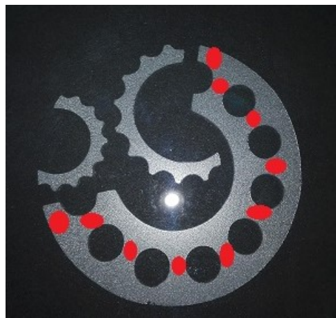
Obr. 32 Laser – měřená místa
