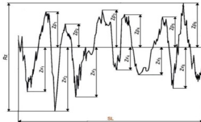
Obr. 4 R_p – největší výška výstupku profilu [1]
