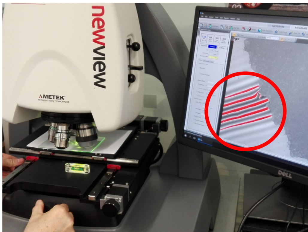
Obr. 26 Hledání interferenčního obrazce
