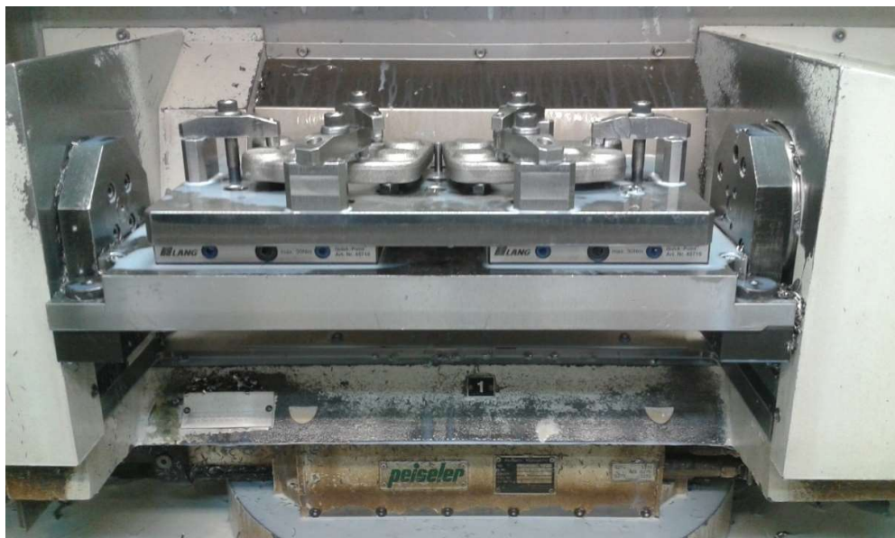
Obr. 79. Přední pohled na reálný obrobek, přípravek a stůl
