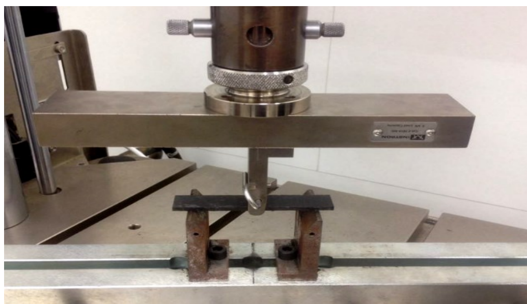
Obrázek č. 86 Tříbodové uspořádání cyklické ohybové zkoušky
