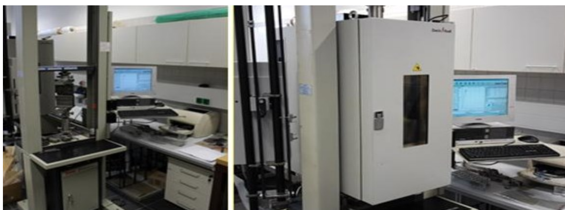
Obrázek č. 63 Zkušební stroj ZWICK 1456 a klimatická komora
