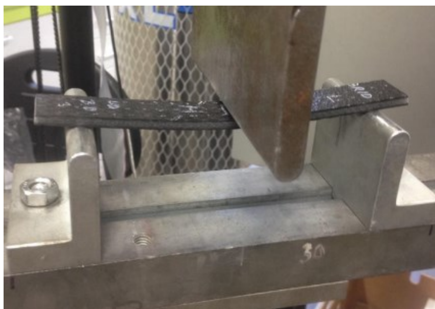
Obrázek č. 84 Třibodové uspořádání statické zkoušky tělesa Hybridní deska
