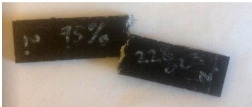
Obrázek č. 99 Zkušební těleso Hybridní deska po 228023 cyklech z 95% Fmax
