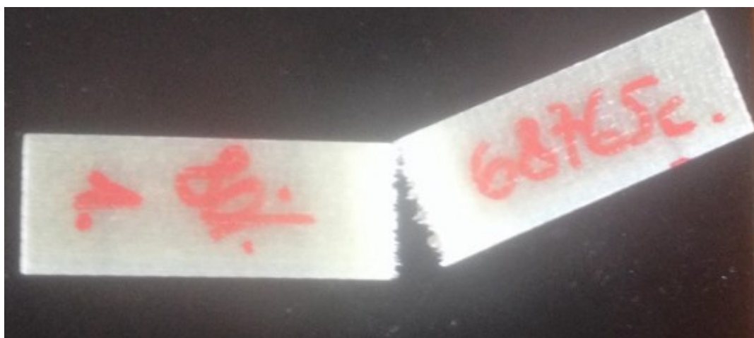
Obrázek č. 91 Zkušební těleso UD Deltapreg VV 430U po 68765 cyklech při 80% z F_{max}
