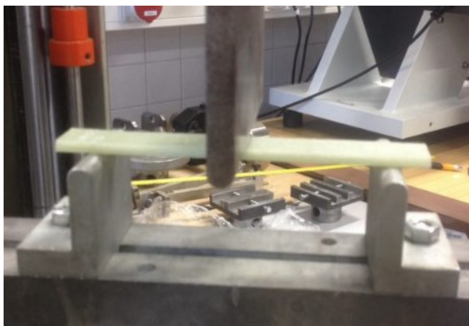
Obrázek č. 80 Tříbodové uspořádání statické zkoušky tělesa UD Deltapreg VV 430U 34%
