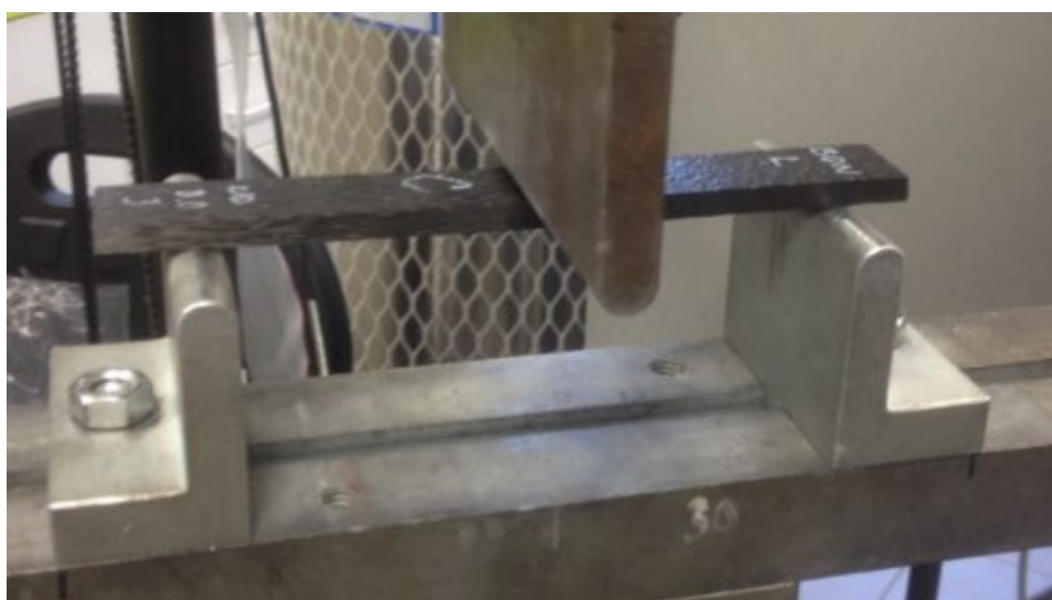
Obrázek č. 82 Tříbodové uspořádání statické zkoušky tělesa UD Carbon IMP GV420 U
