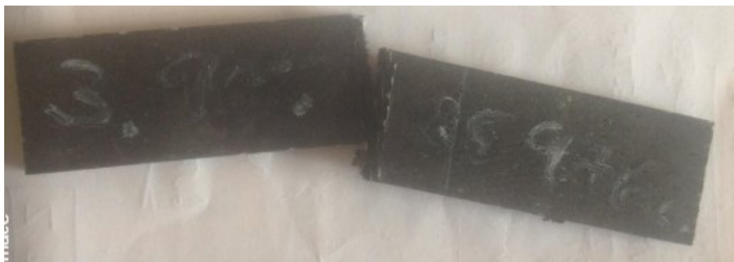
Obrázek č. 95 Zkušební těleso UD Carbon IMP GV 420U po 85976 cyklech z 90% Fmax
