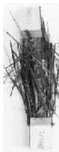
Obrázek č. 38 Vzhled lomu při tahové zkoušce po vystavení vzorku vlhkému prostředí[33]
