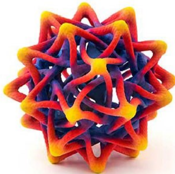
obr. 7 model molekuly vytištěný technologií MJ [13]
