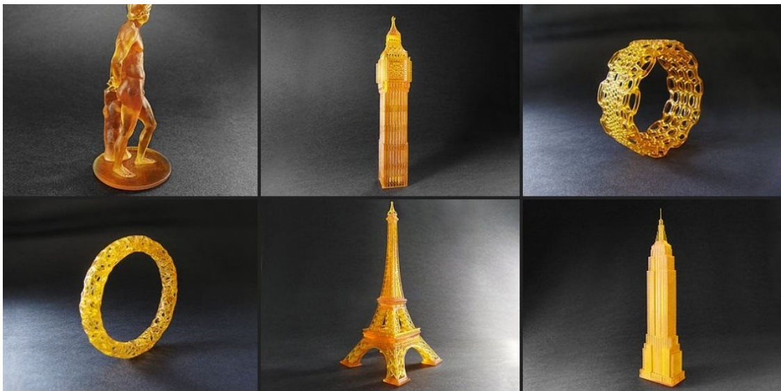
obr. 11 výrobky vytištěné DLP projection [10]
