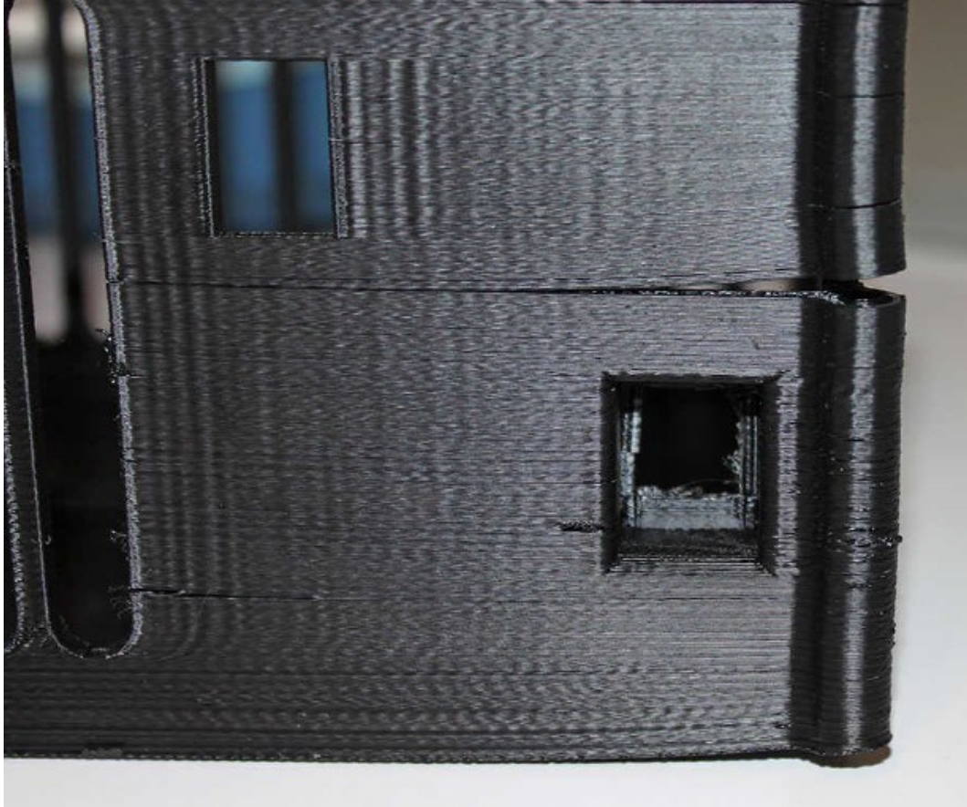
obr. 21 delaminace vrstev vlivem deformace [14]
