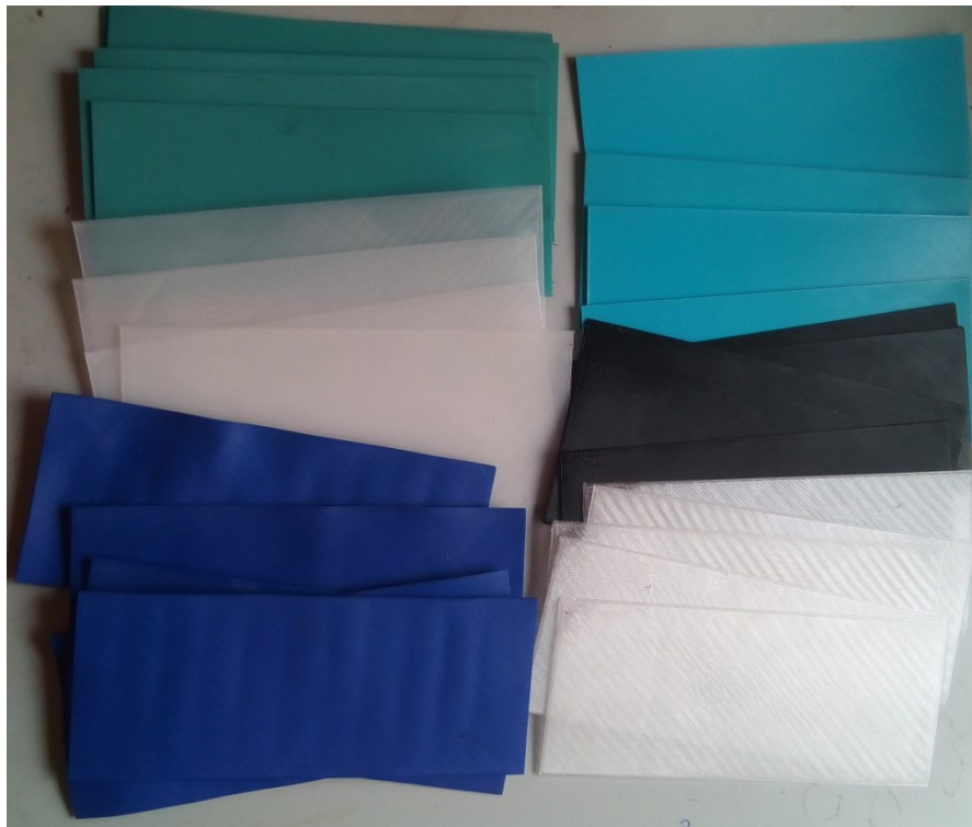
obr. 40 vytisknutá zkušební tělesa
