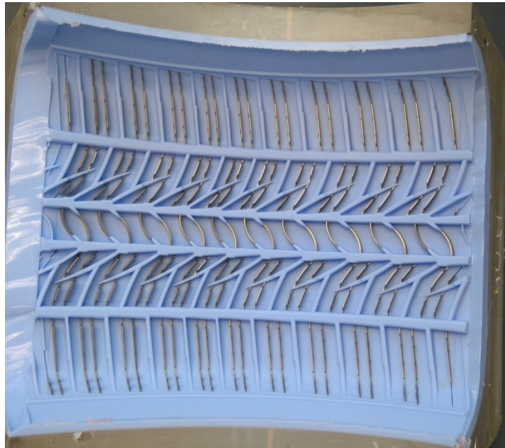
Obr. 27. Silikonová forma osazená lamelami.
