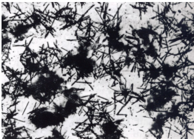
Obr 3. \alpha -hemihydrát síranu vápenatého.
