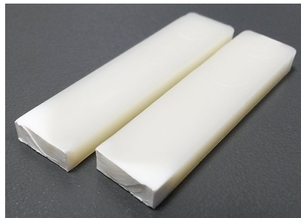
Obr. 89. Zkušební těleso ABS 4H po zkoušce Charpy – křehký lom.
