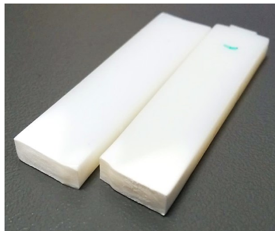
Obr. 54. Zkušební těleso HIPS 4H po zkoušce Charpy – křehký lom.
