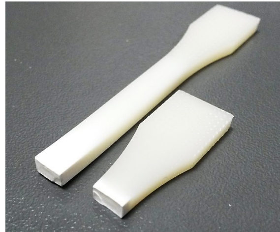
Obr. 86. Zkušební těleso ABS 4H po tahové zkoušce rázem – křehký lom.
