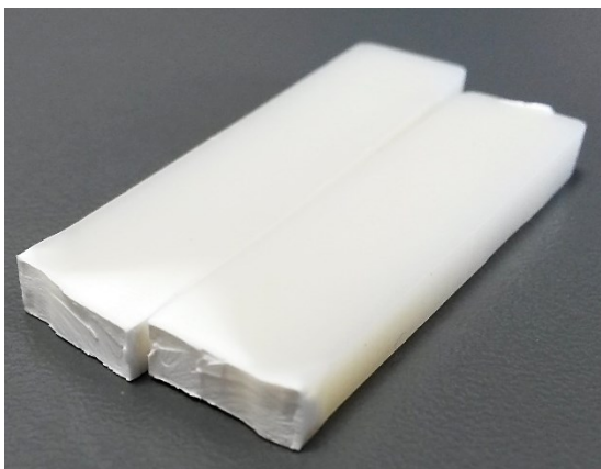
Obr. 88. Zkušební těleso ABS 0 po zkoušce Charpy – křehký lom.
