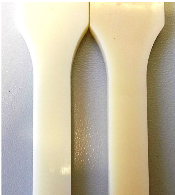
Obr. 96. Srovnání barevnosti klimatizovaného tělesa ABS 4H (vpravo) a originálního ABS.
