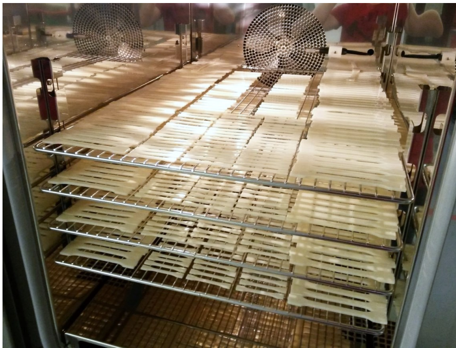
Obr. 31. Umístění zkušebních těles v klimakomoře.
