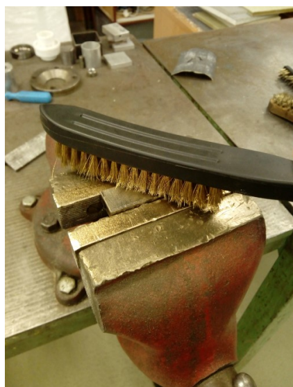
Obr. 20: Čištění kartáčem s mosaznými štětínami o průměru 0,15 mm
