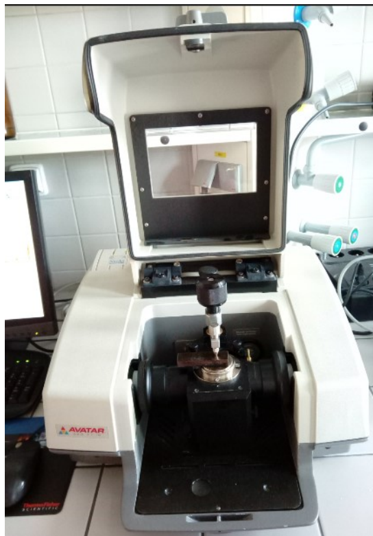
Obr. 28: Infračervený mikroskop Nicolet AVATAR 32D
