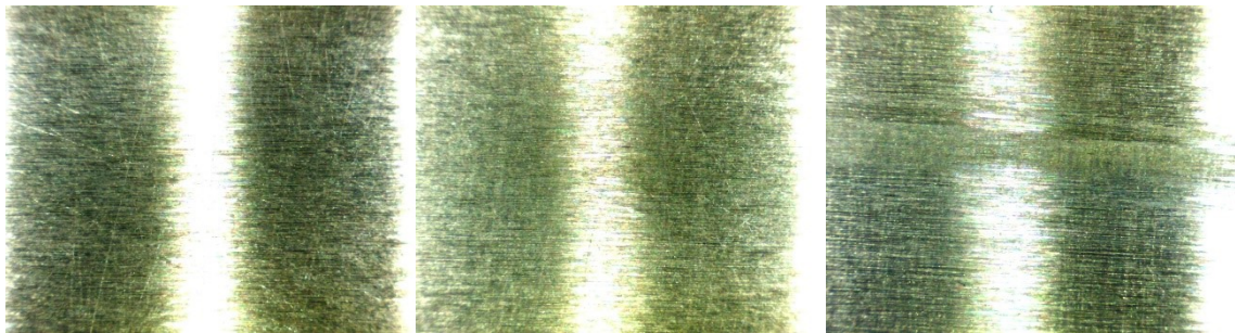
Obr. 60: 1.2312 C před čištěním, po čištění mechanickém a rozdíl mezi mechanickým a chemickým čištěním, zvětšeno 30x
