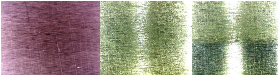
Obr. 63: 1.2316 C před čištěním, po čištění mechanickém a rozdíl mezi mechanickým a chemickým čištěním, zvětšeno 30x
