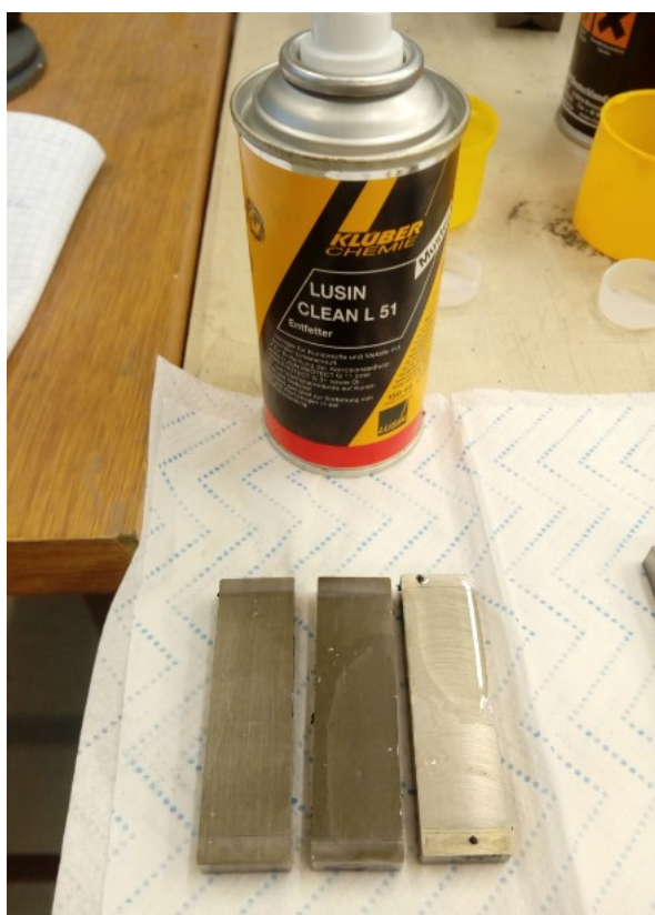
Obr. 29: Použití přípravku Lusin clean L 51 na zkušebních tělesech
