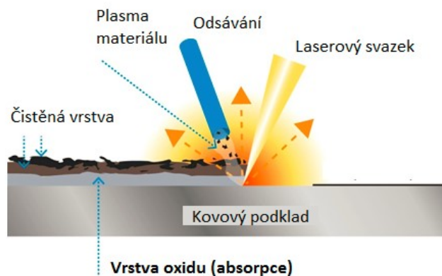
Obr. 14: Princip čištění laserem [30]
