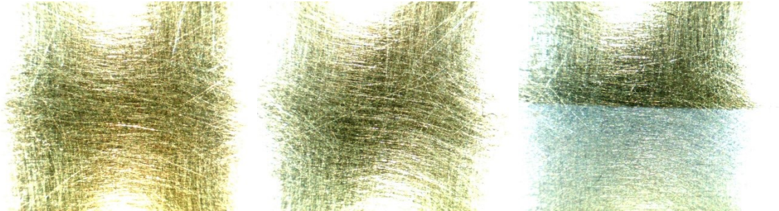
Obr. 59: 1.2312 B před čištěním, po čištění mechanickém a rozdíl mezi mechanickým a chemickým čištěním, zvětšeno 30x
