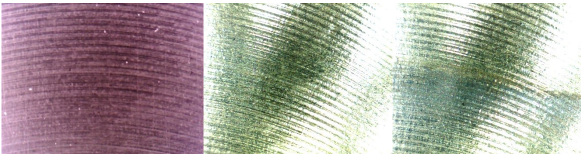
Obr. 64: 1.2316 D před čištěním, po čištění mechanickém a rozdíl mezi mechanickým a chemickým čištěním, zvětšeno 30x
