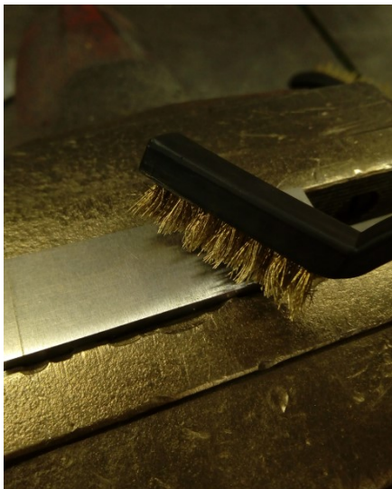
Obr. 21: Čištění kartáčem s mosaznými štětinami o průměru 0,2 mm
