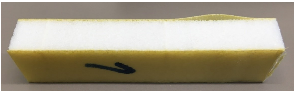
Obr. 38: Skúšobná vzorka s vonkajšími vrstvami zloženými z 1 prepregu
