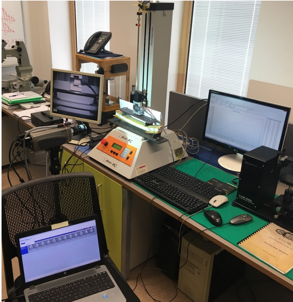
Obr. 45: Meracie prístroje a technika použitá pri skúške štvorbodovým ohybom
