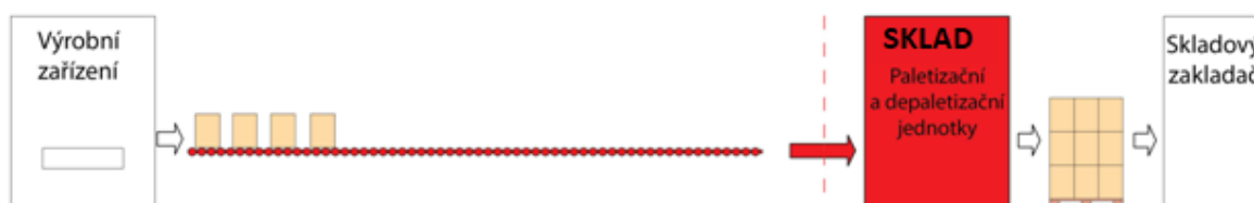
Obrázek 45 – Princip fungování válečkových dopravníků
