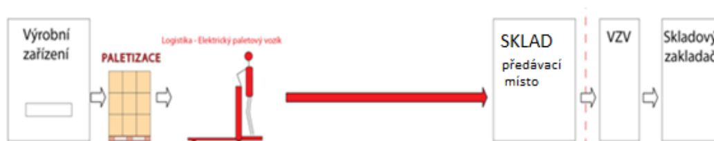
Obrázek 22 – Princip odvozu hotových palet (vlastní zpracování)
