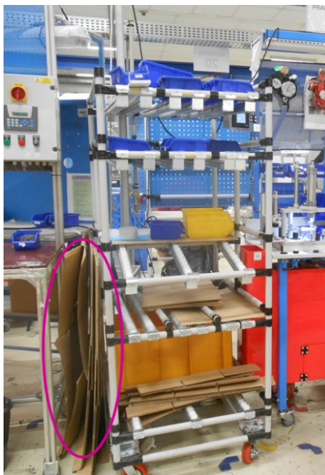
Obr. 68 Nevhodně umístěný obalový materiál (vlastní zpracování)
