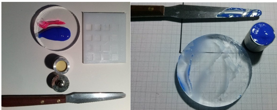
Obr. 2 Nanesení otiskovací hmoty do přípravku
