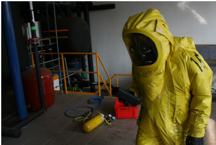
Obrázek 16 Finální měření koncentrace amoniaku ve vzduchu po odstranění závady
