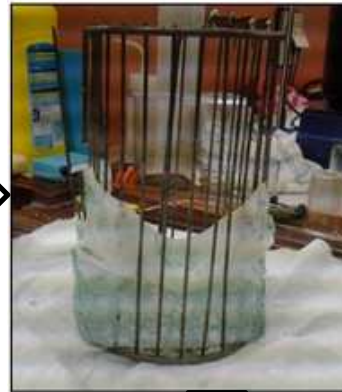
PVB fólie upnutá v rámu před a po delaminaci.
