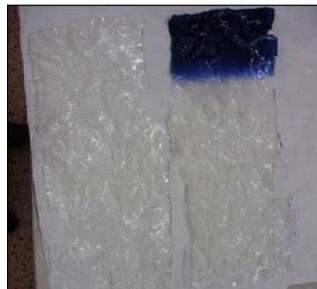
Delaminovaná fólie. Na vzorku vpravo je tmavý pruh, který byl pře dalším zpracováním odstraněn.
