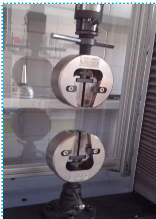
Obr. 6: Čelisti trhacího stroje Shimadzu, AG-X
