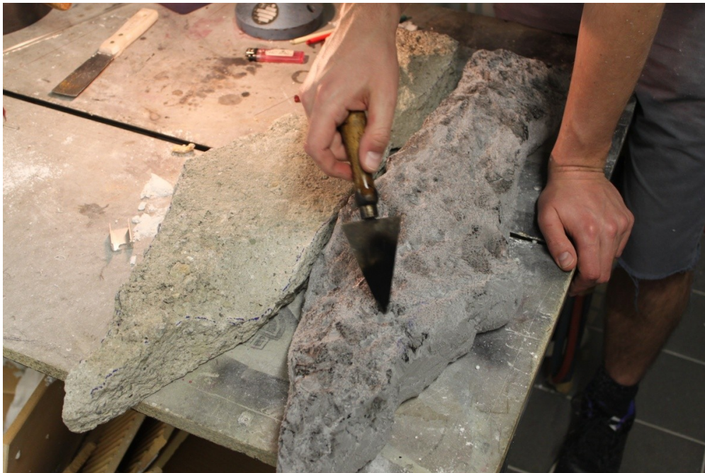
Obr. 24 Výroba jádra pro formu na tavení skla
