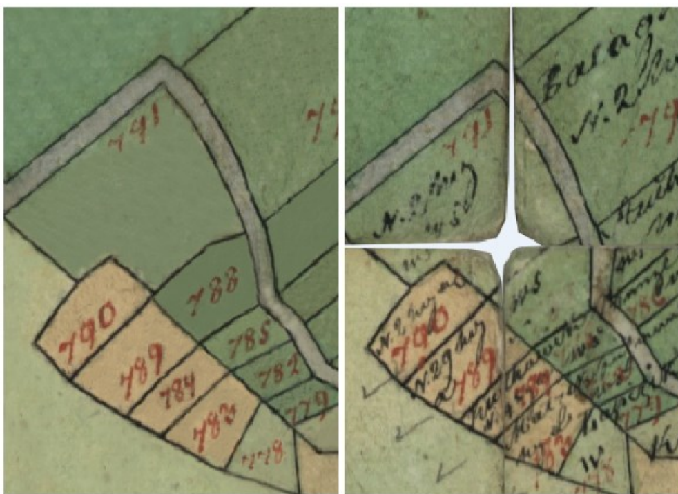
Obrázek 38 – Nalevo zahlazené spoje, napravo nedokonalá návaznost spojů
